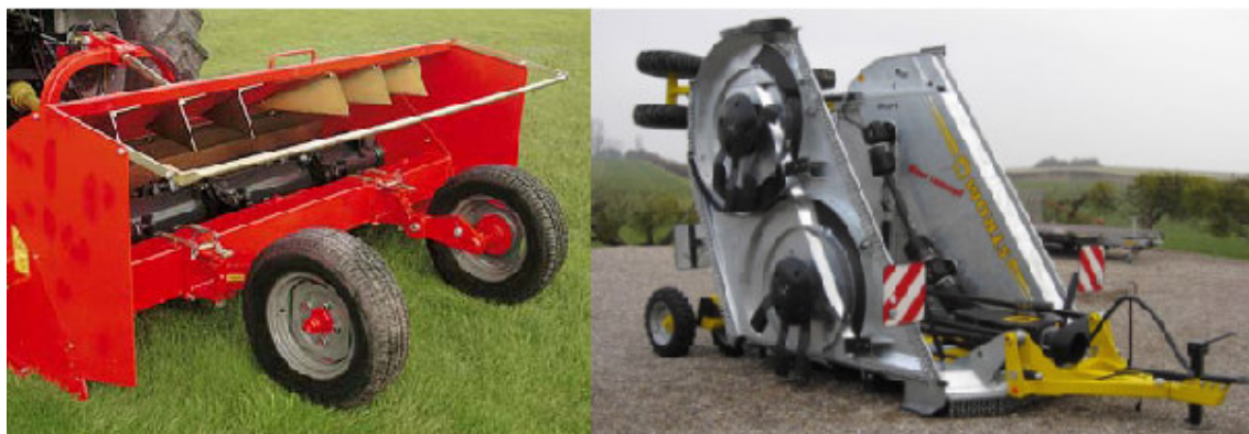
Obr. 8: Vlevo mulčovač s vodorovnou osou rotace, vpravo se svislou osou rotace
