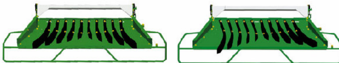
Obr. 18: Nastavení deflektorů při působení bočního větru
