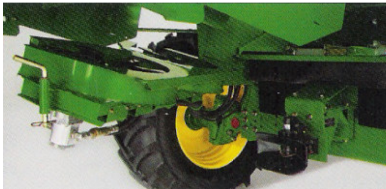
Obr. 27: Vyklopení mechanického rozmetače pro zjednodušení údržby
