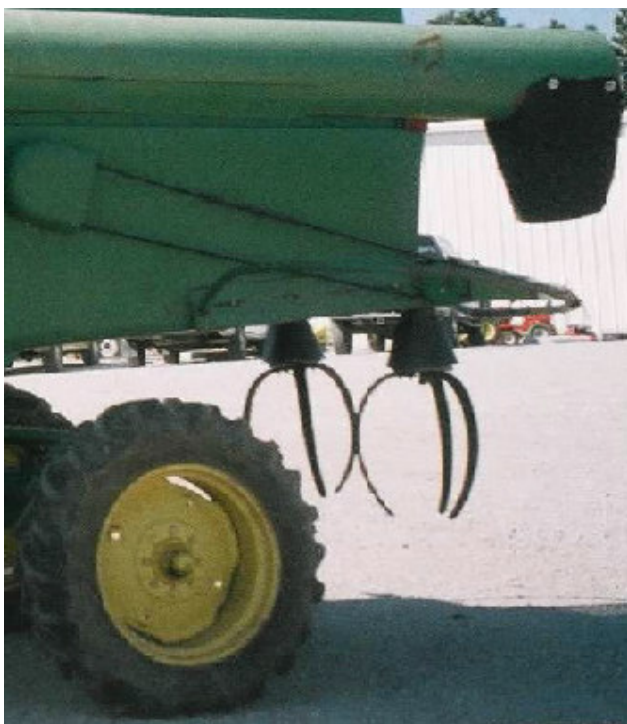
Obr. 9: Drtič s vodorovnou osou rotace vpravo, vlevo drtič se svislou osou rotace
