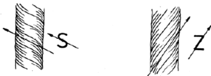
Obrázek 2 - Znázornění a označení směru zákrutu
