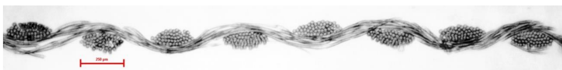
Obrázek 21 - Podélný řez tkaninou P 49/26
