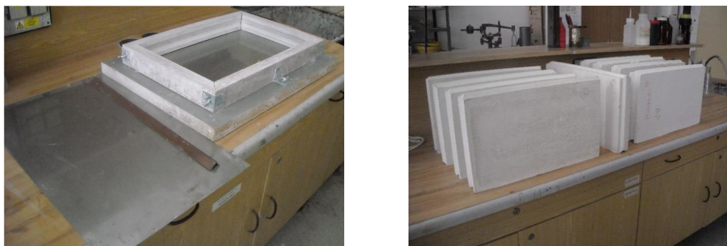
Obrázek 5: Ukázka poloprovozní formy (vlevo) a výsledného produktu (vpravo)
