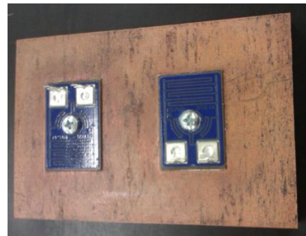
Obrázek 28 Ploché topné těleso a jeho upevnění k měděné destičce [40]
