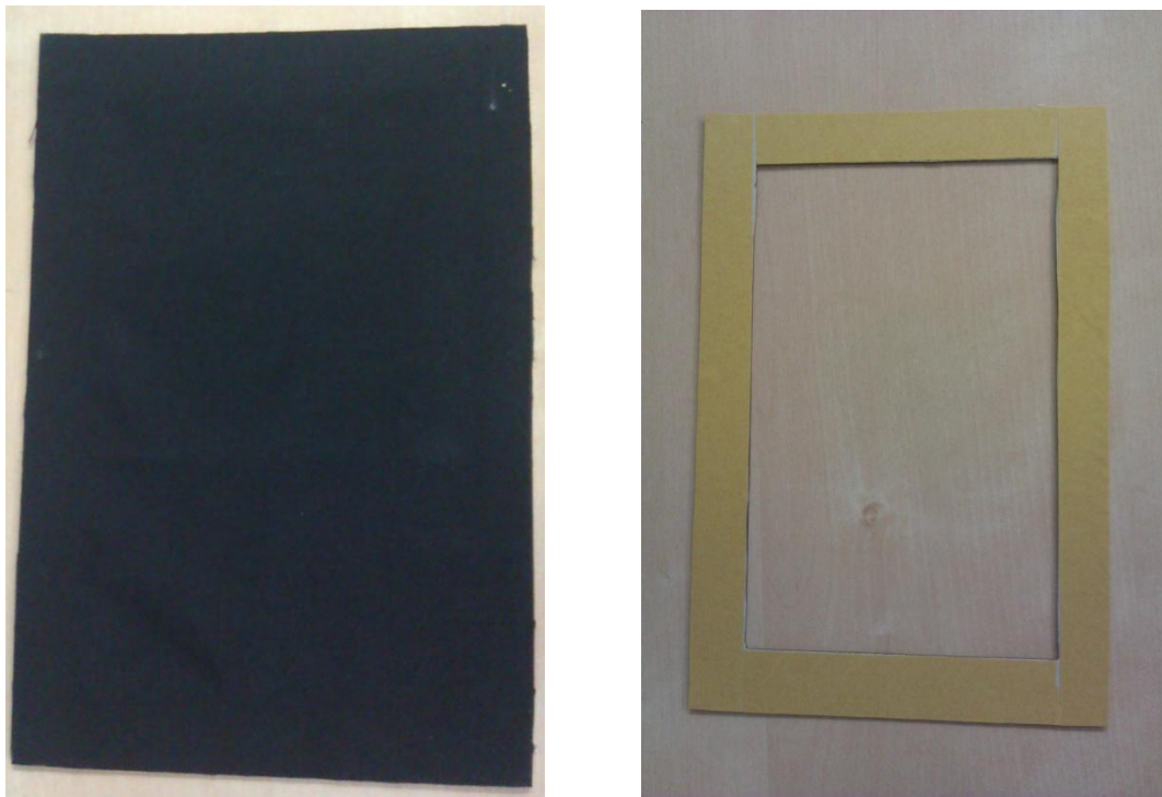
Obr. 19 Rámeček pro snadné umístění měřené textilie do měřícího tunelu s textilií a bez textilie
