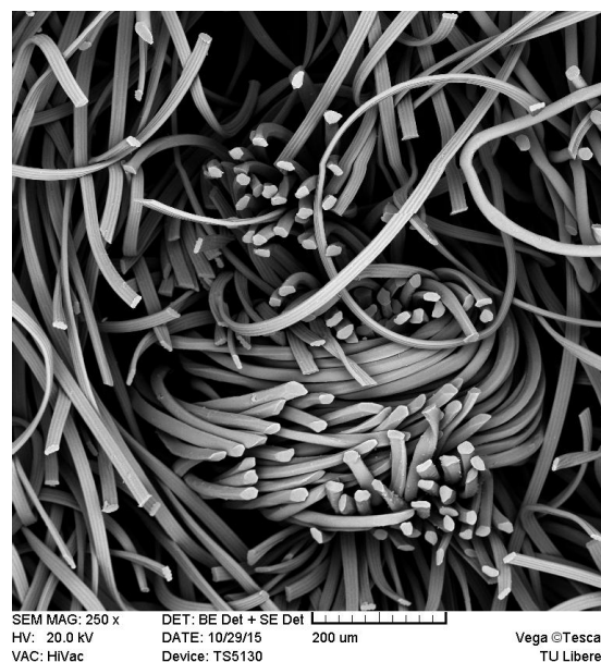
Obr. 8 Materiál Polartec podélný řez – zvětšení 50 x a příčný řez – zvětšení 250 x
