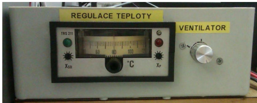
Obr. 13 Elektrikářská krabička pro regulaci teploty a regulaci rychlosti proudění vzduchu ve vytvořeném tunelu – pohled zepředu
