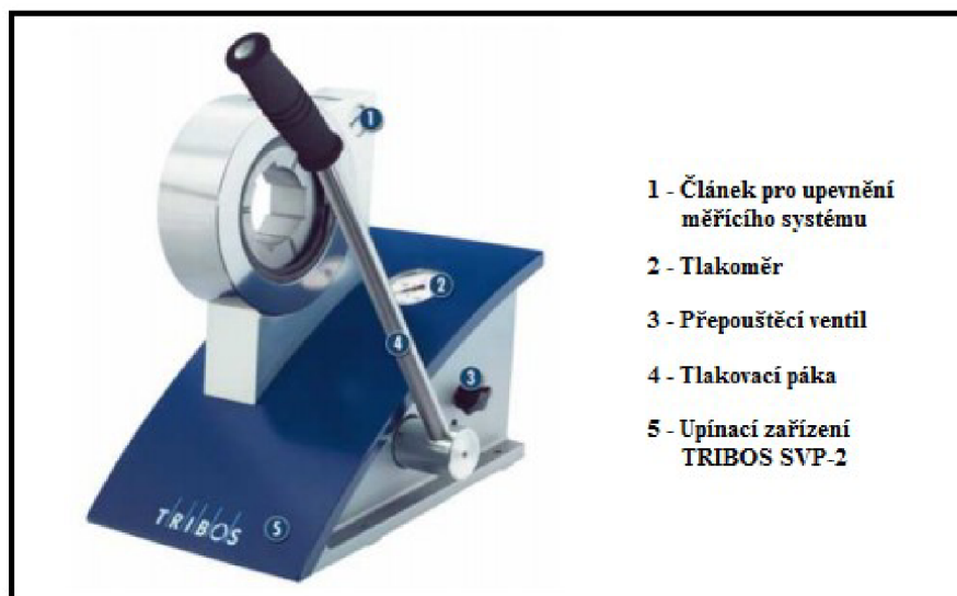
Obr. 3.7 Upínací zařízení TRIBOS SVP-2. [23]
