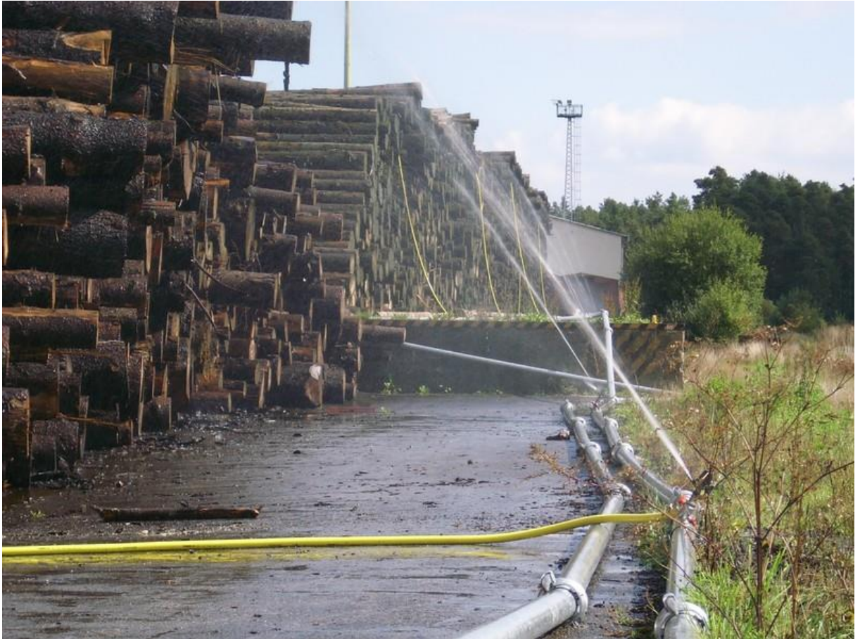
Obrázek č. 10 Ochrana kulatiny postřikem
