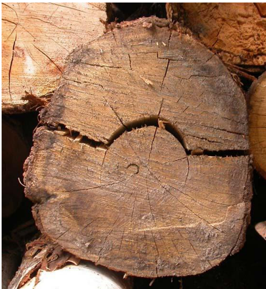
Obrázek č. 2 Odlupčivá trhlina
