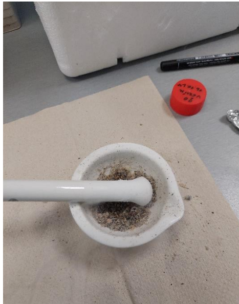
Obrázek 4: Proces homogenizace včel s tekutým dusíkem (vlastní fotografie)
