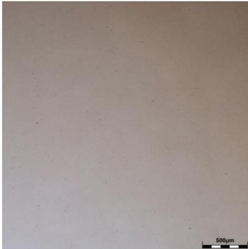
Obr. 46 Vyleštěný povrch vzorku zobrazen mikroskopem Olympus GX51.
