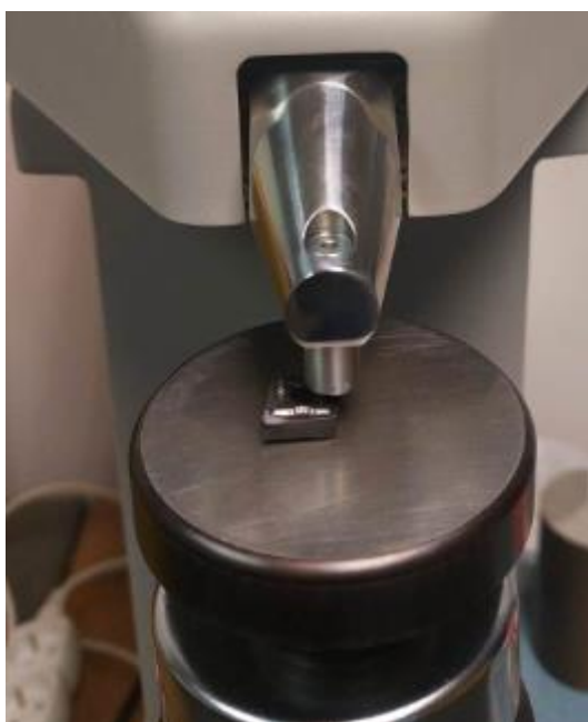
Obr. 56 Provedení vpichu tvrdoměrem Zwick/Roell ZHR.
