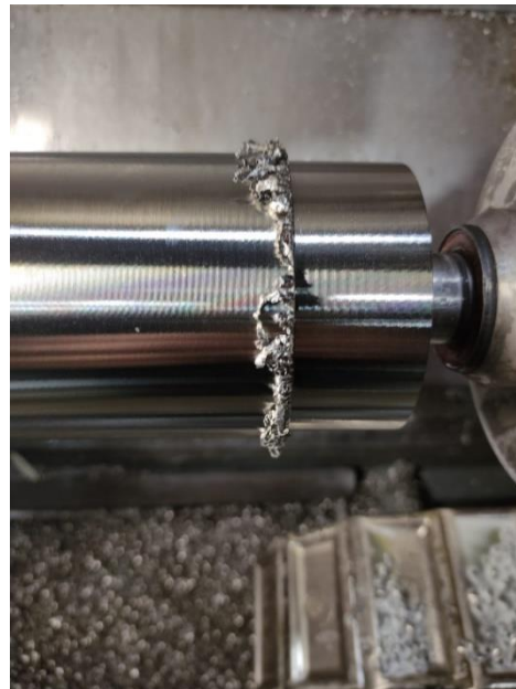
Obr. 63 Otřep na obrobku, vzorek F2.
