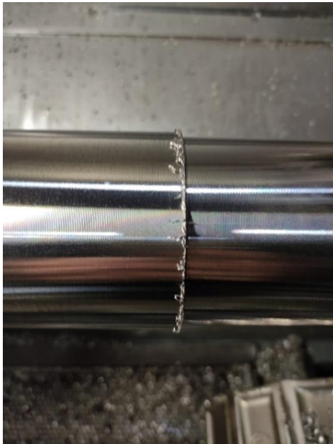
Obr. 62 Otřep na obrobku, vzorek A1.
