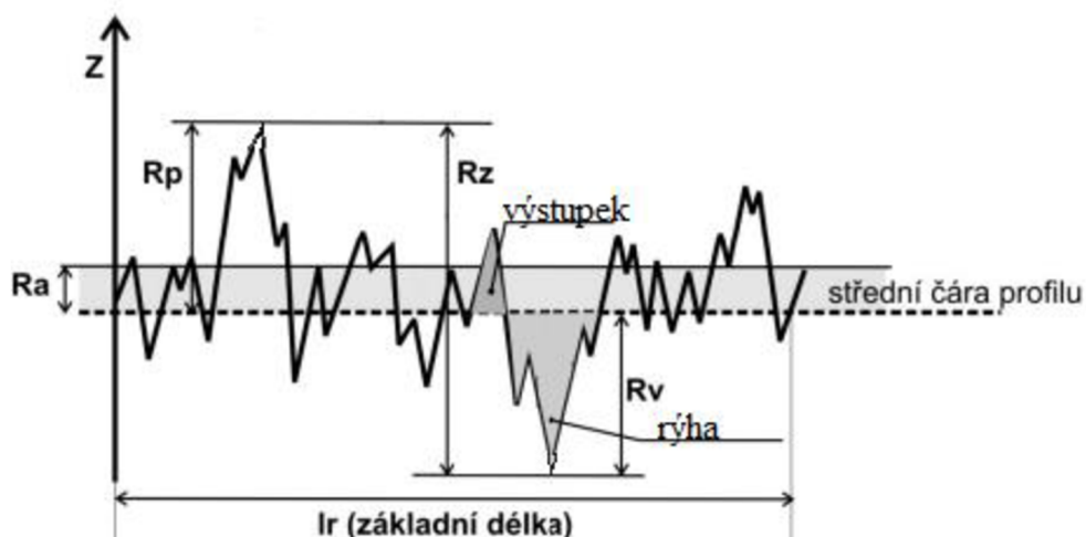
Obr. 24 Parametry hodnocení drsnosti povrchu [32].
