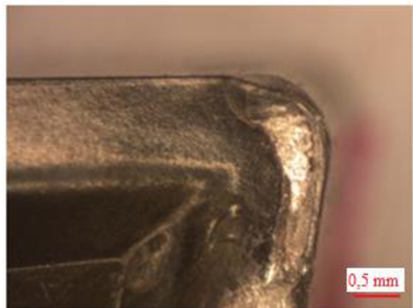
Obr. 48 Výmol na čele a plastická deformace vzorku E1.
