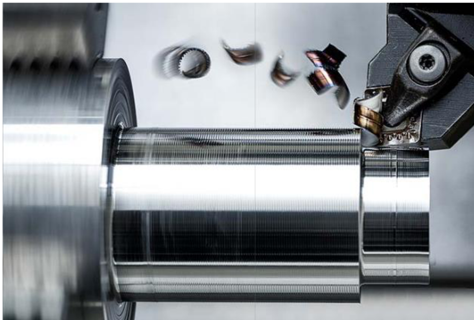
Obr. 1 Podélné válcové soustružení [1].
