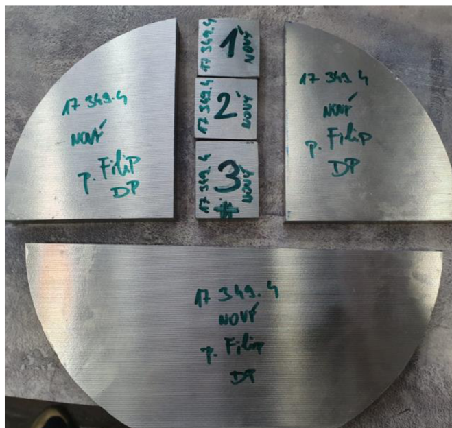
Obr. 42 Řezání vzorků z obráběného polotovaru.
