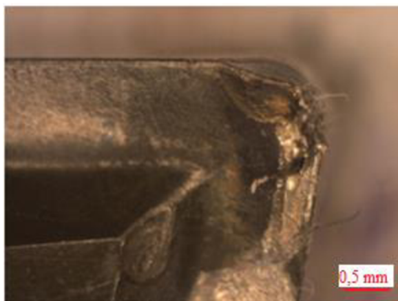
Obr. 47 Výmol na čele a plastická deformace vzorku D2.
