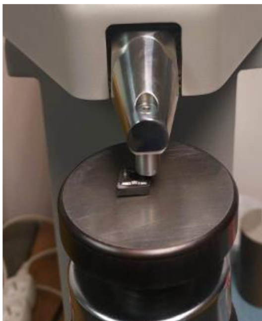
Obr. 56 Provedení vpichu tvrdoměrem Zwick/Roell ZHR.
