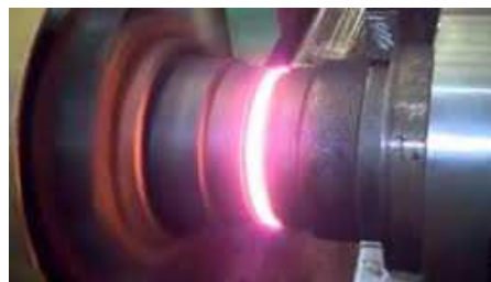
Obr. 15 Ohřátí v místě tření
