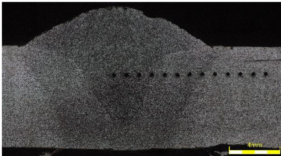
Obr.3.12 Místa vpichu na vzorku s hodnotou vneseného tepla při navařování 14 kJ
