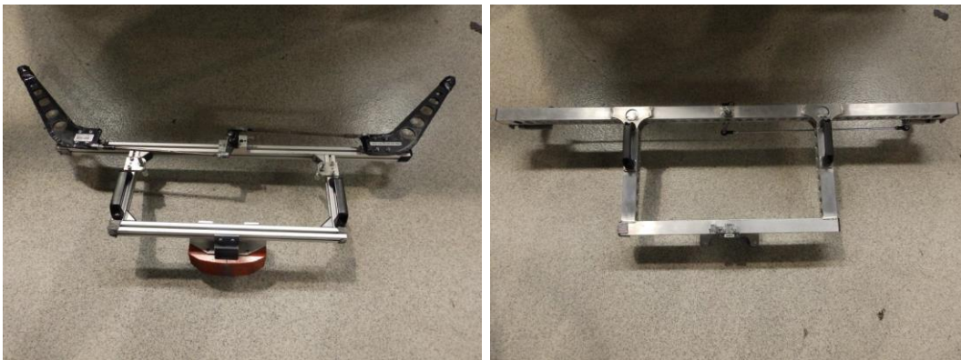
Obr. 13 Starý versus nový přípravek na ustavení světlometů SK26x
