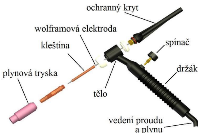
Obr. 28 Schéma svařovacího TIG hořáku [36]
