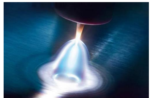
Obr. 11 Elektrický oblouk TIG [15]
