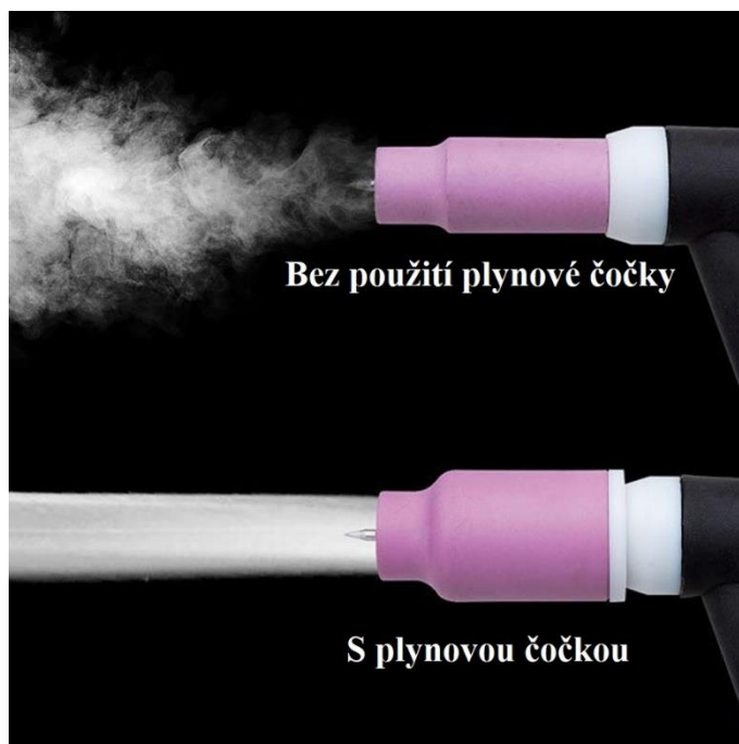
Obr. 29 Vliv plynové čočky na tok plynu [37]
