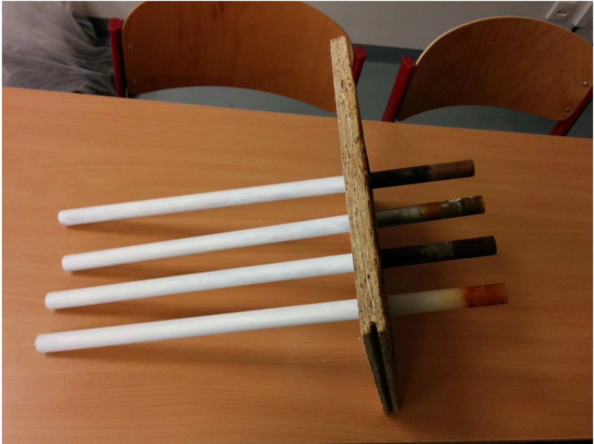
Obrázek 4: Pozorovaná část tyčí nastříkaná bílou barvou ve spreji. Zdola nahoru: Nylon, ocel, dural, měď.
