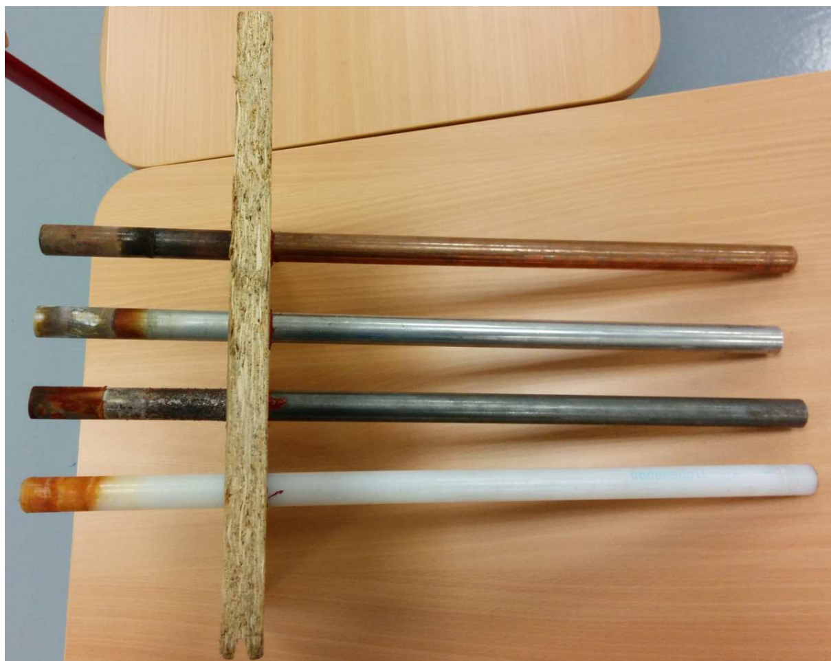
Obrázek 3: Materiály vsazené do OSB desky a již uchycené silikonem. Zdola nahoru: Nylon, ocel, dural a měď.
