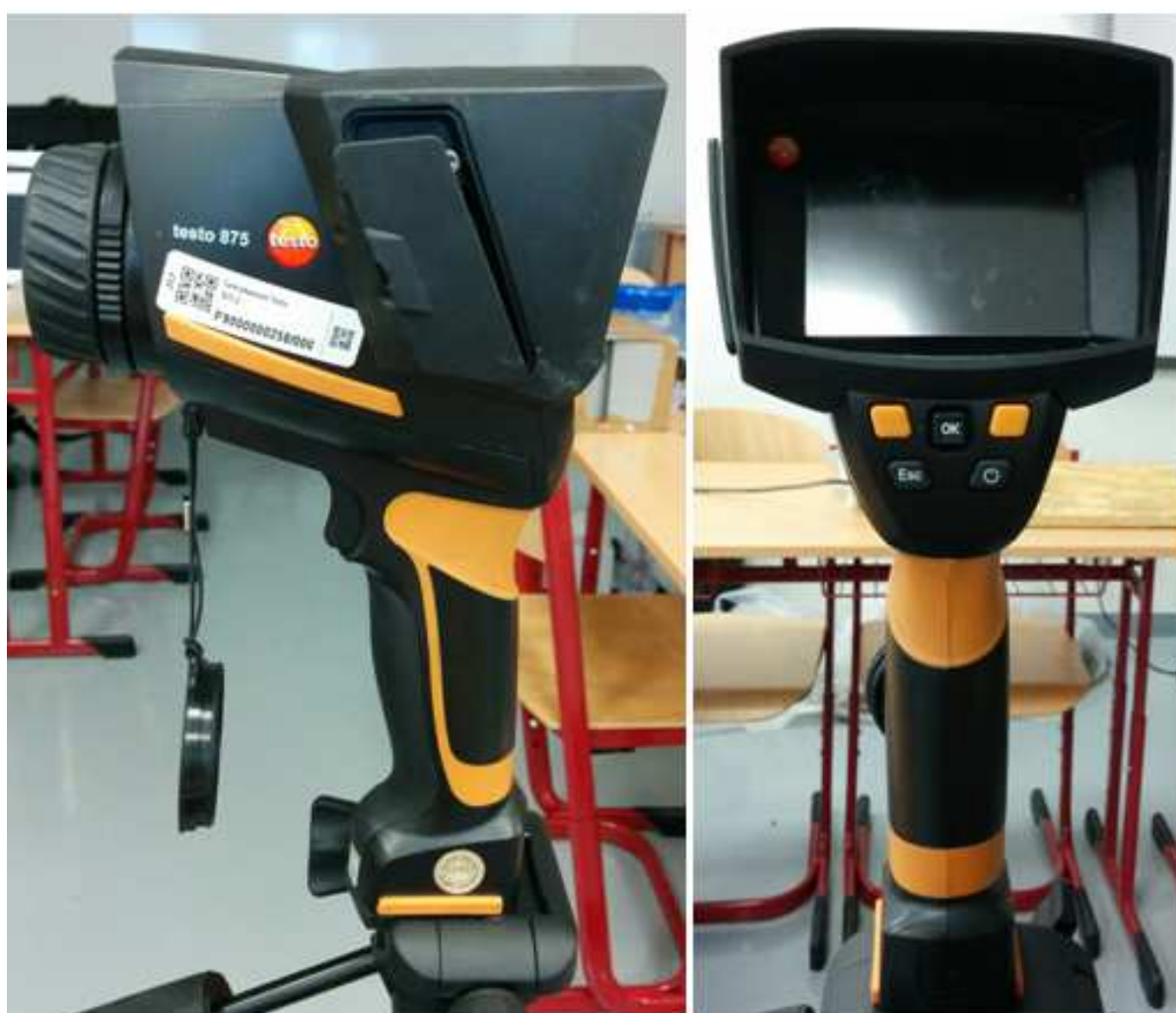
Obrázek 2: Termokamera Testo 875-2. Vlevo boční pohled, vpravo pohled na displej a ovládání.
