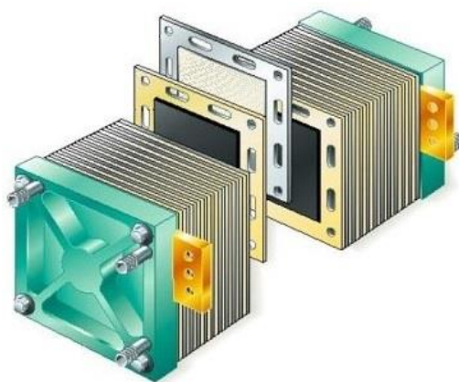
Obr. 8: Sestava palivového článku [5]
