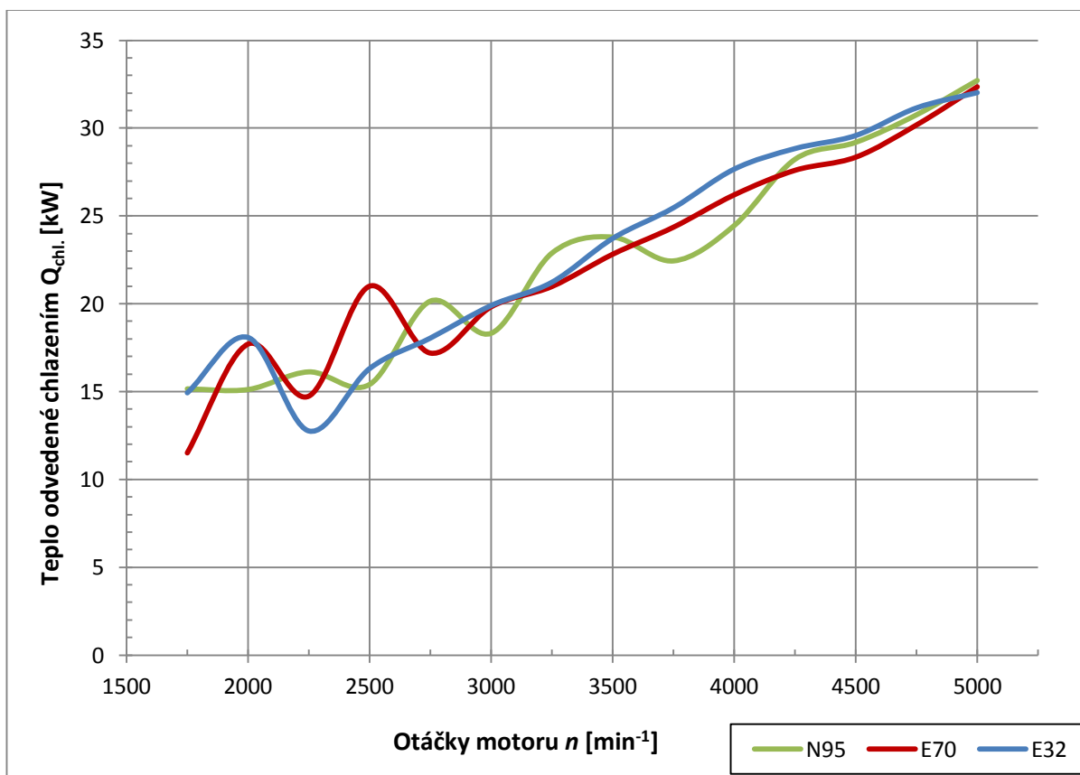
Obr. 21: Grafické znázornění průběhů tepla odvedeného chlazením
