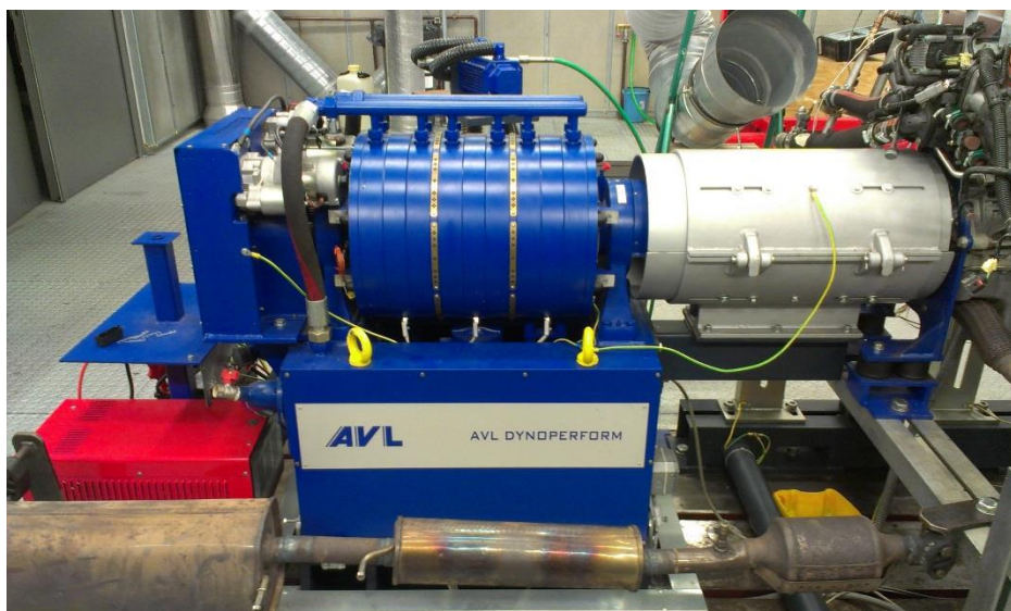
Obr. 16: Elektrický vířivý dynamometr AVL DynoPerform 240 (Mendelu Brno) [vlastní]
