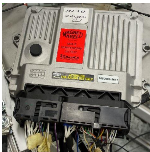
Obr. 12: Programovatelná řídicí jednotka Magneti Marelli SRA-E [vlastní]
