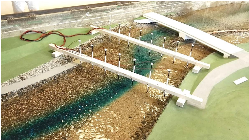
Obr. 7.14 – Vizualizace šíření znečištění vodným roztokem brilantní modři
