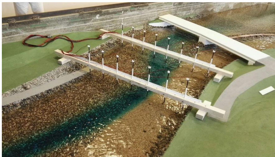
Obr. 9.1 – Vizualizace proudění vodným roztokem brilantní modří
