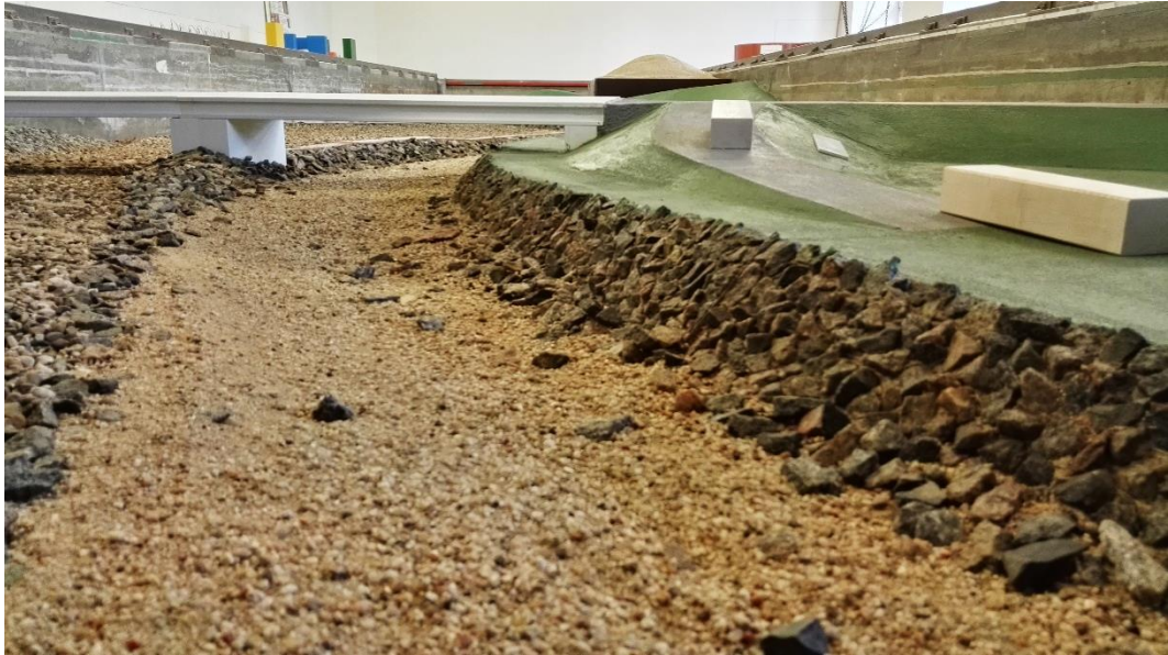
Obr. 4.2 – Pohyblivé dno modelu
