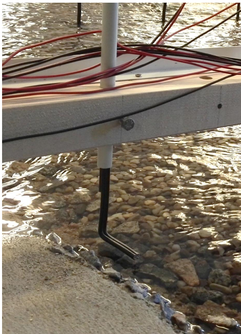
Obr. 8.1 – Měřicí sonda 7 nad hladinou vody
