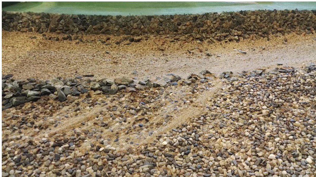
Obr. 7.4 - Dno fyzikálního modelu po hydrodynamickém zatížení
