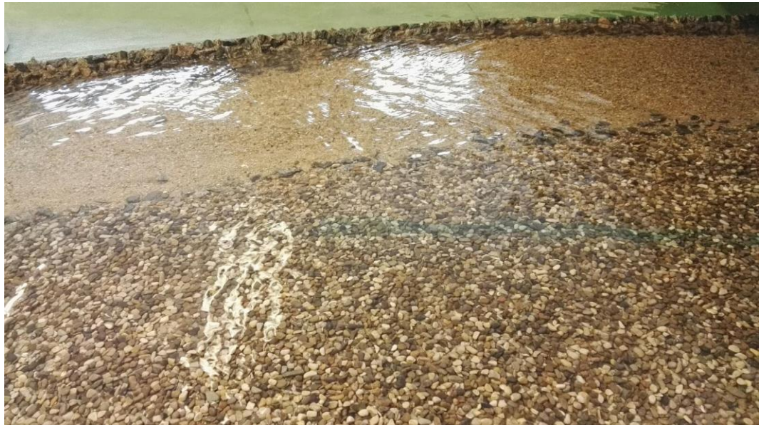
Obr. 7.3 – Hydrodynamické zatížení dna modelu
