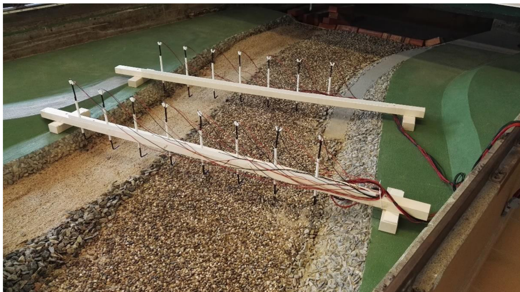
Obr. 6.2 – Situace měřících elektrod na fyzikálním modelu vodního toku
