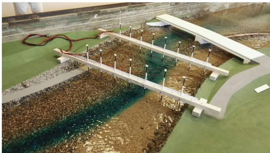
Obr. 9.1 – Vizualizace proudění vodným roztokem brilantní modří
