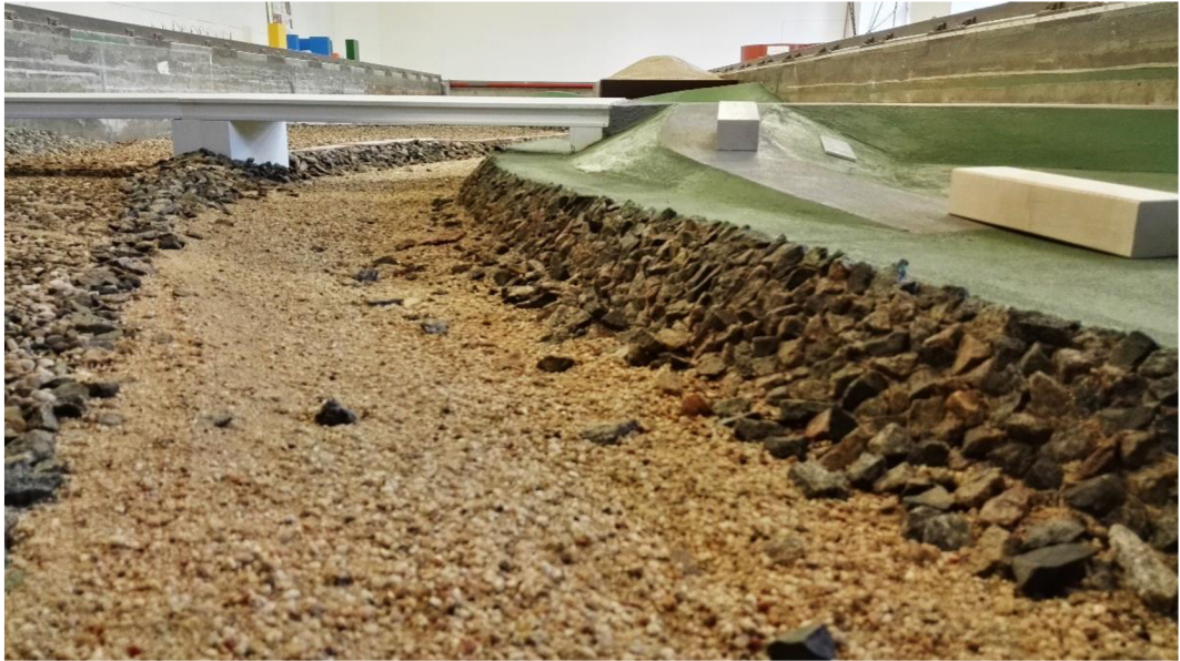
Obr. 4.2 – Pohyblivé dno modelu
