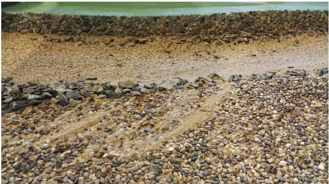
Obr. 7.4 - Dno fyzikálního modelu po hydrodynamickém zatížení
