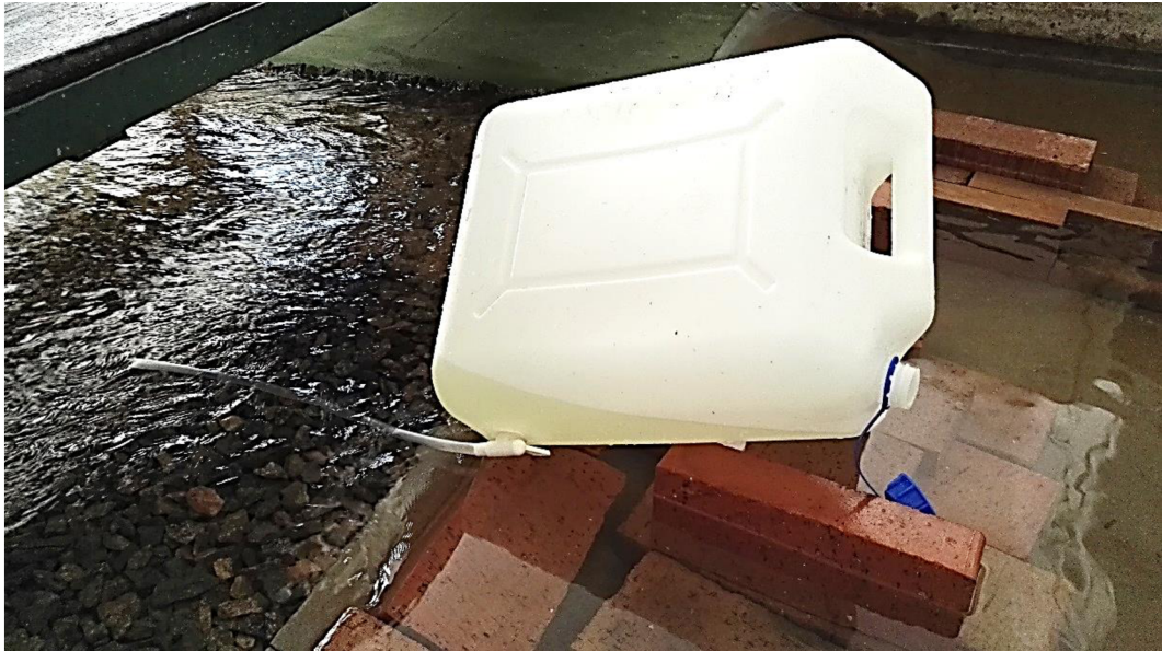
Obr. 7.11 – Umístění barelu s plastovou hadičkou na kohoutu
