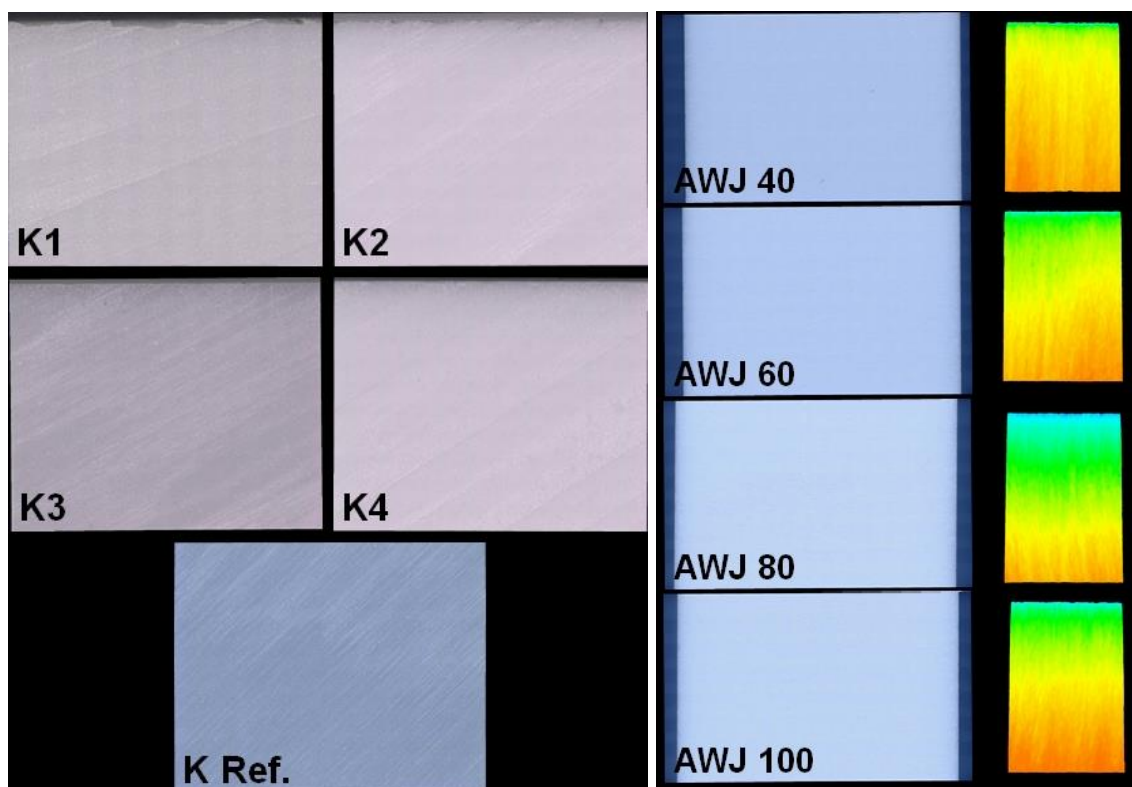
Příloha 3 Corian Designer White – ukázky nasnímaných vzorků řezaných pilovými kotouči (vlevo) a abrazivním vodním paprskem (vpravo)
