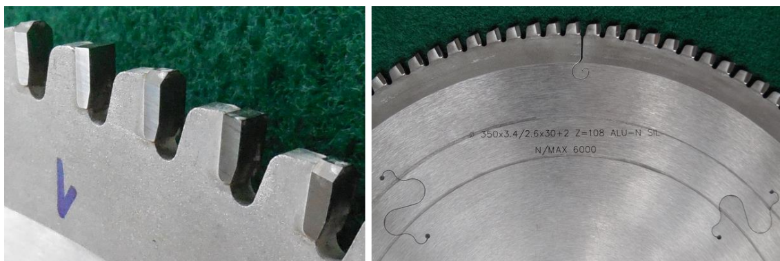
Obr. 70 Pilový kotouč K1 – zuby a úpravy těla kotouče
