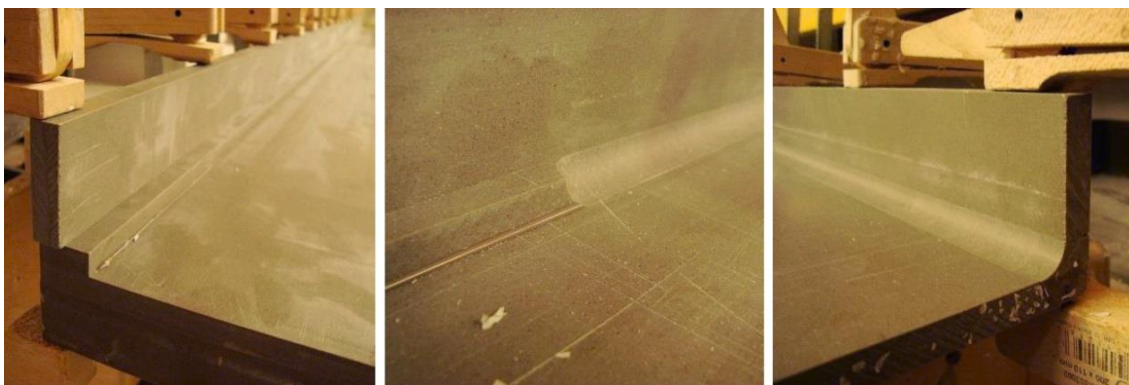
Obr. 6 Postup frézování těsnicí lišty kuchyňské pracovní desky (Závacký, 2015)
