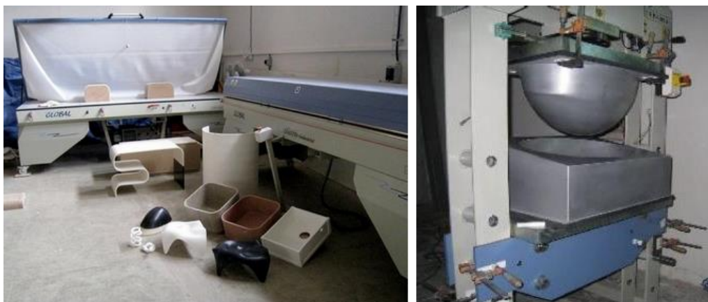
Obr. 9 Membránový lis se speciální pecí na prohřátí desky (vlevo) a hydraulický lis (vpravo)
