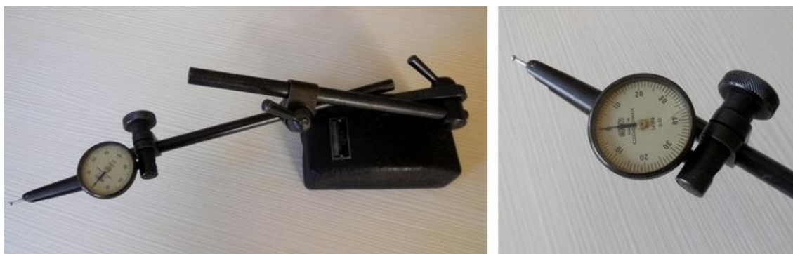
Obr. 60 Přístroj KINEX, vlevo snímání hrot s ukazatelem hodnot
