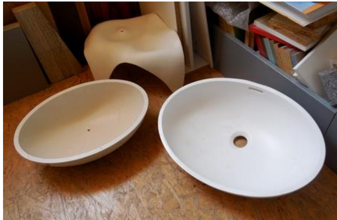
Obr. 10 Ukázka tvarování Solid surface v membránovém („stolička“) a hydraulickém (umyvadla) lisu
