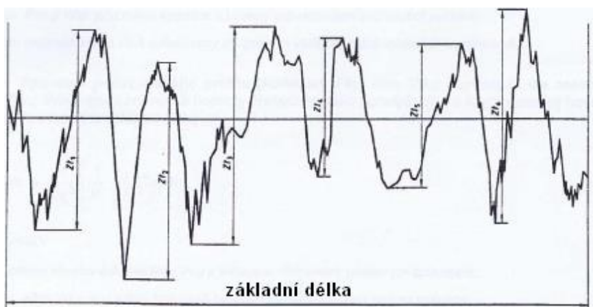
Obr. 36 Průměrná výška prvků profilu (ČSN EN ISO 4287:1998, 1999)
