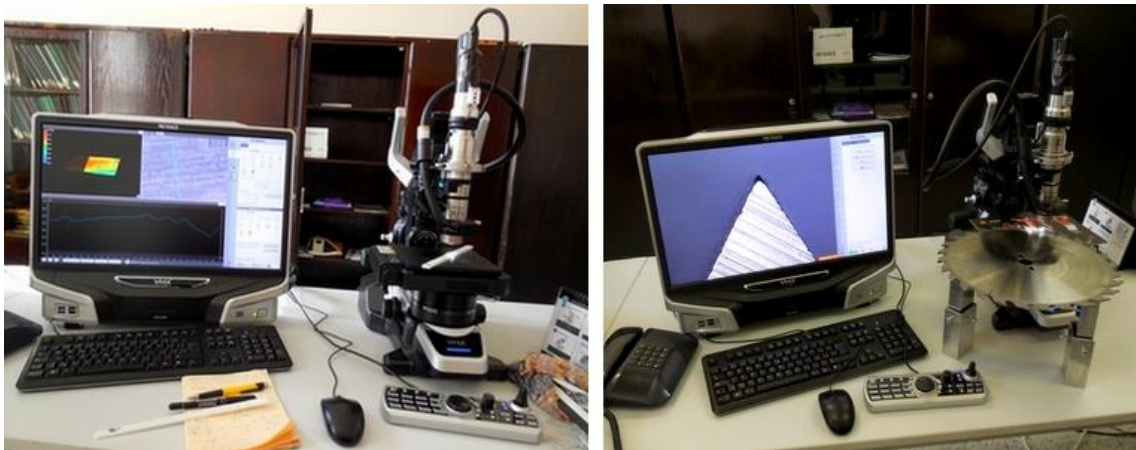
Obr. 63 Vyhodnocování nasnímaného povrchu (vlevo) a měření poloměru otupení ostří (vpravo) na mikroskopu VHX-5000
