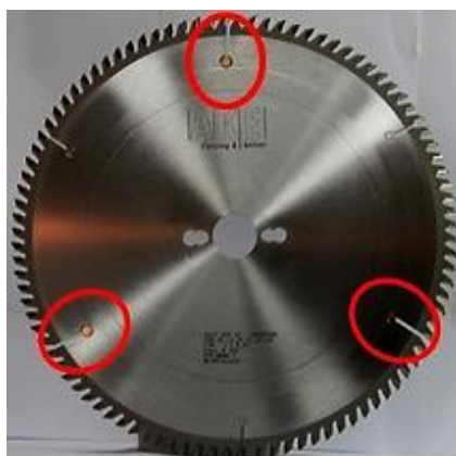
Obr. 27 Ukázka měděných nýtů na pilovém kotouči AKE
