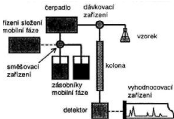
Obr. 9 Schéma kapalinového chromatografu (KLOUDA, 2003)
