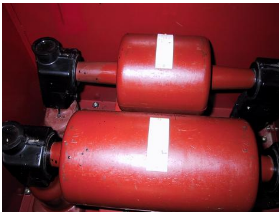
Obr. 8 Príklad poškodenia vnútornými čiastkovými výbojmi
