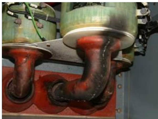
Obr. 7 Príklady poškodenia povrchovými čiastkovými výbojmi
