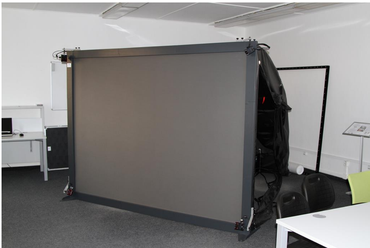
Obr. 23: Powerwall - mobilní stereoskopická stěna
