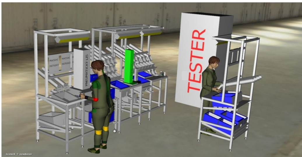
Obr. 34: Model výrobního pracoviště pro výrobu pneumatických komponent v prostředí VDP 9.1 - ergonomická analýza
