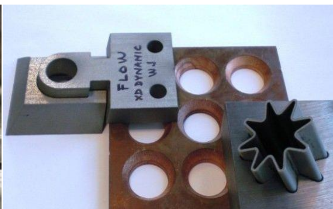
Obr. 3.9 Výsledky tvarového řezání s použitím technologie Dynamic Waterjet [27].
