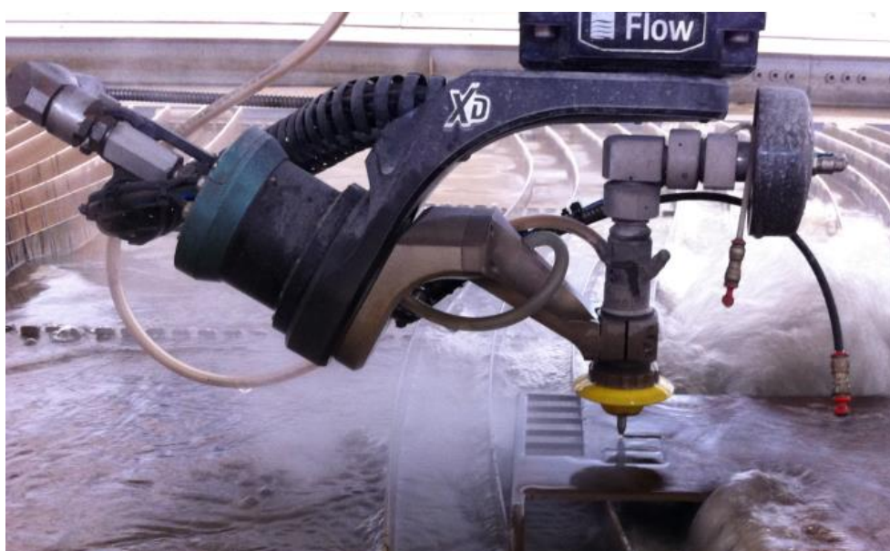
Obr. 3.25 Řezání vzorků na stroji Mach 4C (DWJ).
