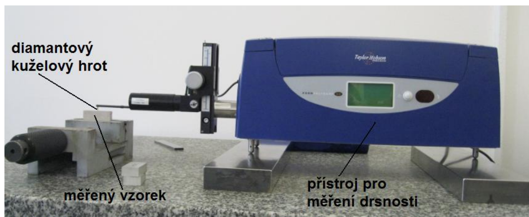
Obr. 3.22 Měření drsnosti vzorků na přístroji Talysurf Intra 50.
