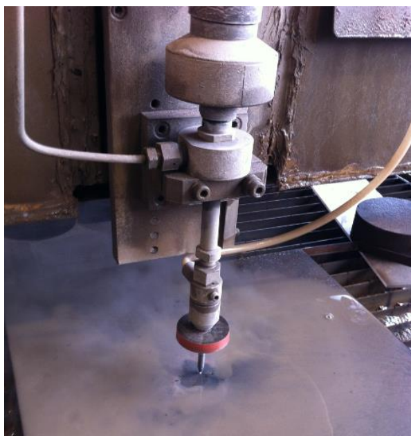
Obr. 3.24 Řezání vzorků na stroji AquaCut 4001.25 (AWJ).
