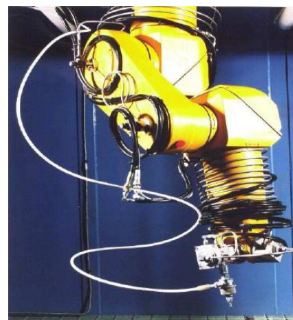
Obr. 3.2 Ukázka robotické ruky s řezací hlavou na konci [29].
