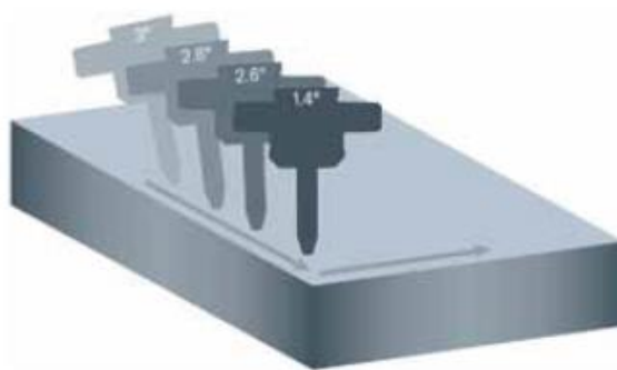
Obr. 3.5 Korekce úkosů pomocí naklápění abrazivní hlavice [30].
