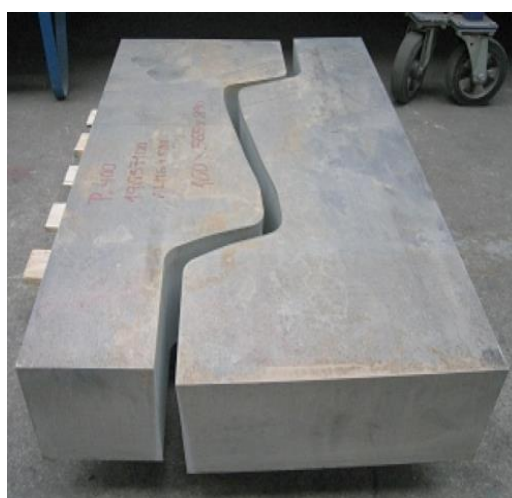
Obr. 1.38 Řez durallem o tl. 160 mm [19].
