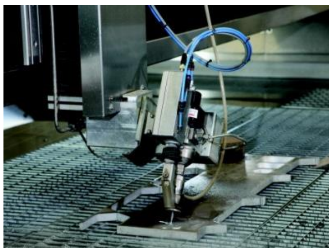
Obr. 3.13 Ukázka použití systému ProgressJet 5AX při řezání 3D výřezů z deskového polotovaru [20].
