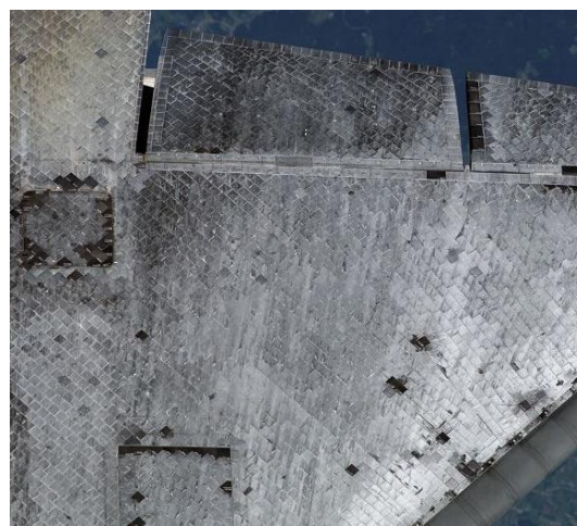
Obr. 1.6 Spodní strana raketoplánu s keramickými dlaždicemi [8].
