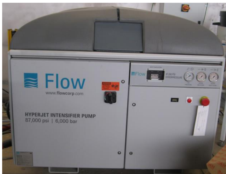
Obr. 3.12 Čerpadlo s tlakem 6 000 barů.
