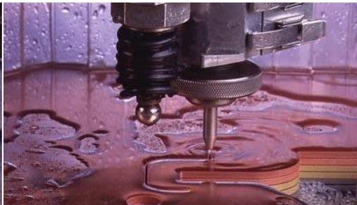
Obr. 3.7 Ukázka řezání více vrstev najednou pomocí technologie DWJ [27].
