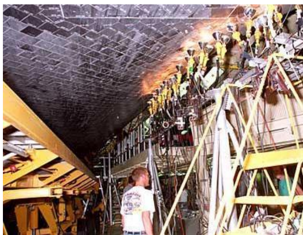
Obr. 1.5 Nanášení dlaždic tepelného štítu raketoplánu [8].
