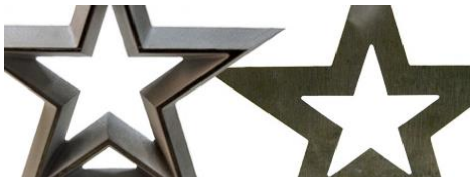
Obr. 3.10 Řezání ve 3D a současná korekce úkosů [12].
