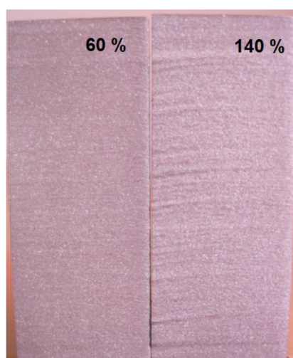
Obr. 3.32 Řezáno technologií AWJ.
