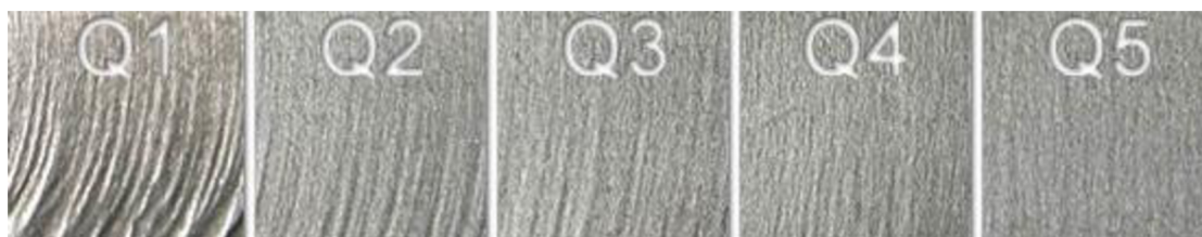
Q1 - separáčn í řez, Q2 – hrubý řez, Q3 - čistý řez, Q4 – kvalitní řez, Q5 - excelentní řez
