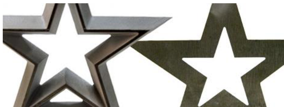
Obr. 3.10 Řezání ve 3D a současná korekce úkosů [12].
