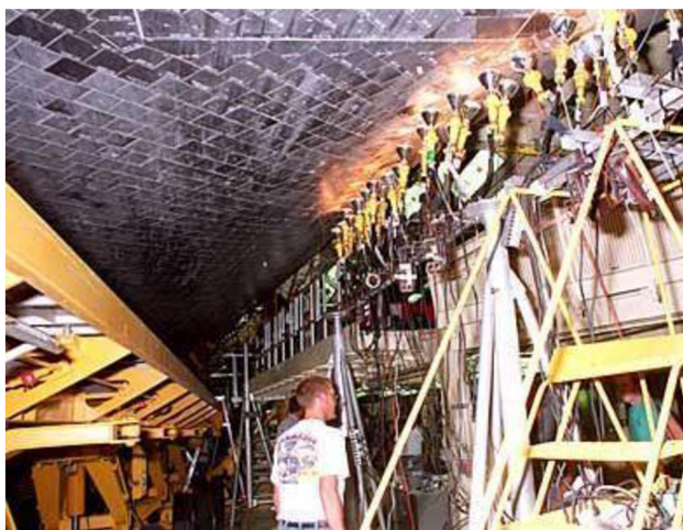
Obr. 1.5 Nanášení dlaždic tepelného štítu raketoplánu [8].
