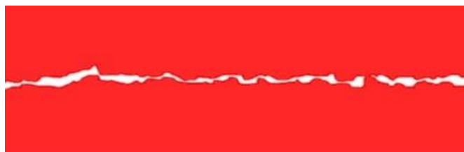
Obrázek 3 Princip vzniku otěrových částí při mezním tření (Černý 2010b)
