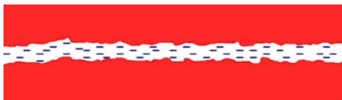
Obrázek 4 Kovové plochy oddělené vrstvou oleje (Černý, 2010b)
