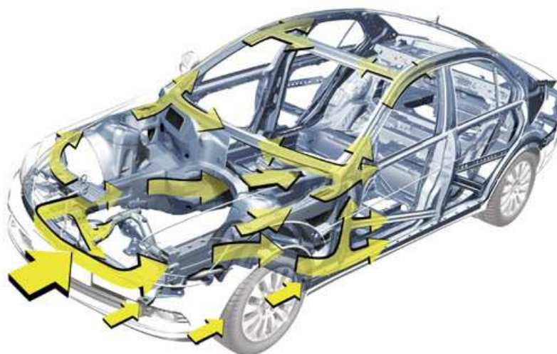
Obr. 2 – Rozložení síly v karoserii při čelním nárazu vozidla
