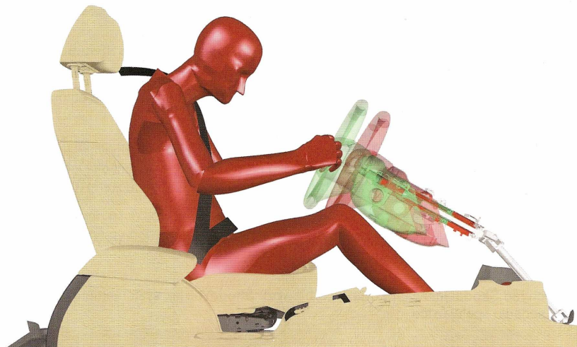
Obr. 15 – Posunutí mechanismu řízení při nárazu
