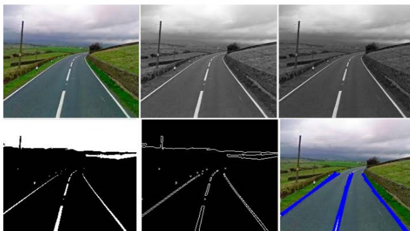
Obr. 16 Průběh algoritmu detekce jízdních pruhů na zachyceném snímku [30]
