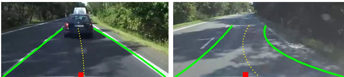
Obr. 50 Ukázka detekce při jízdě v blízkosti vozidla z výhledu (vlevo) a detekce při oslnění kamery (vpravo)
