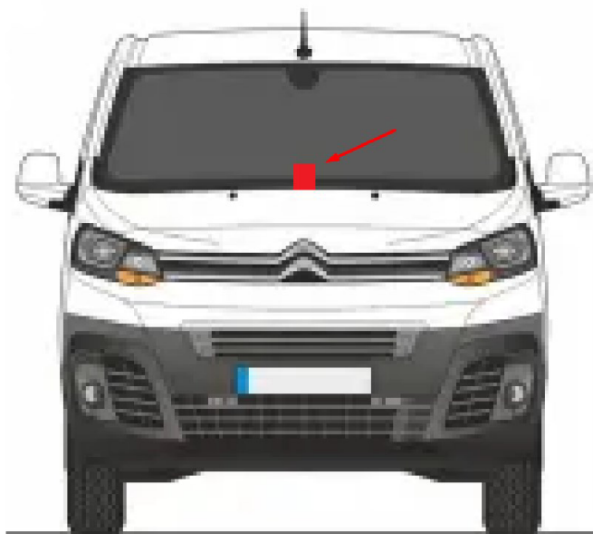
Obr. 26 Umístění kamery ZED 2 ve vozidle
