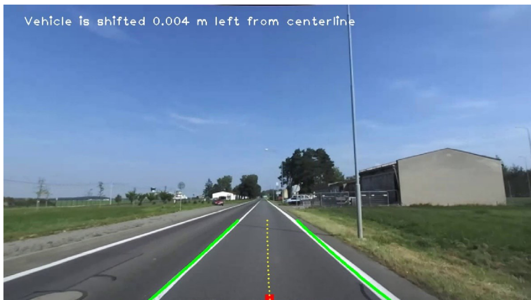
Obr. 45 Ukázka vizualizace výstupů jednotlivých částí systému při jízdě po rovině – hranice jízdního pruhu (zeleně), navržená trajektorie (žlutě), poloha středu vozidla (červeně), aktuální poloha vozidla vůči trajektorii (bílý text)
