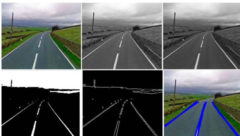
Obr. 16 Průběh algoritmu detekce jízdám pruhů na zachyceném snímku [30]
