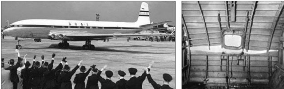
Obr. 2: Pohled na dopravní letadlo typu Comet a jeho rozlomení v blízkosti oken [17]
