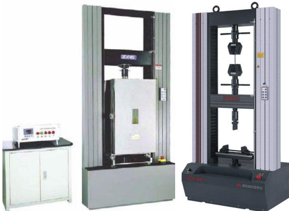
Obr. 23: Elektromechanický univerzální testovací stroj SANS CMT5105 [20]
