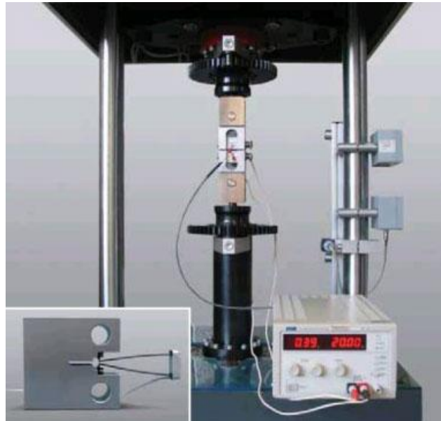
Obr. 20: Zkušební vzorek namáhaný excentrickým tahem [18]
