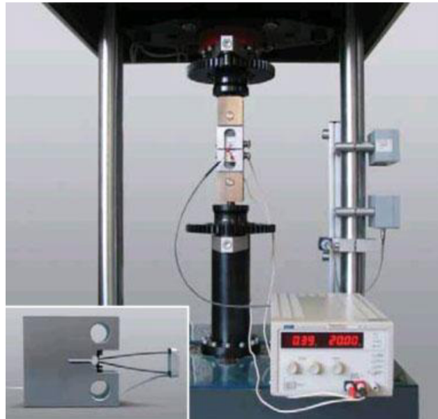
Obr. 20: Zkušební vzorek namáhaný excentrickým tahem [18]
