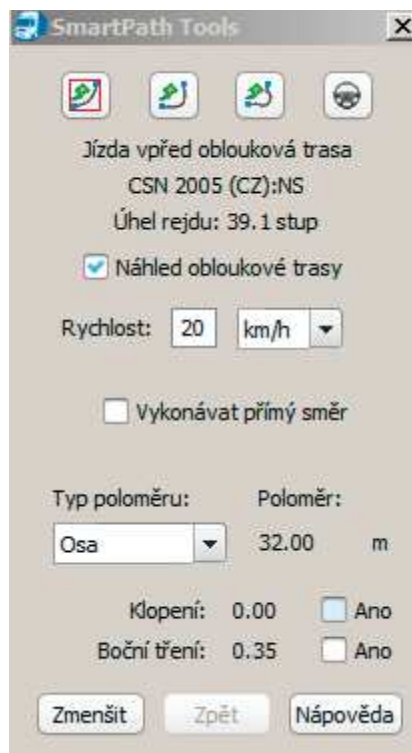
Obr. 106 Ukázka nastavení parametrů vozidel pro simulaci průjezdu navrženými TOK
