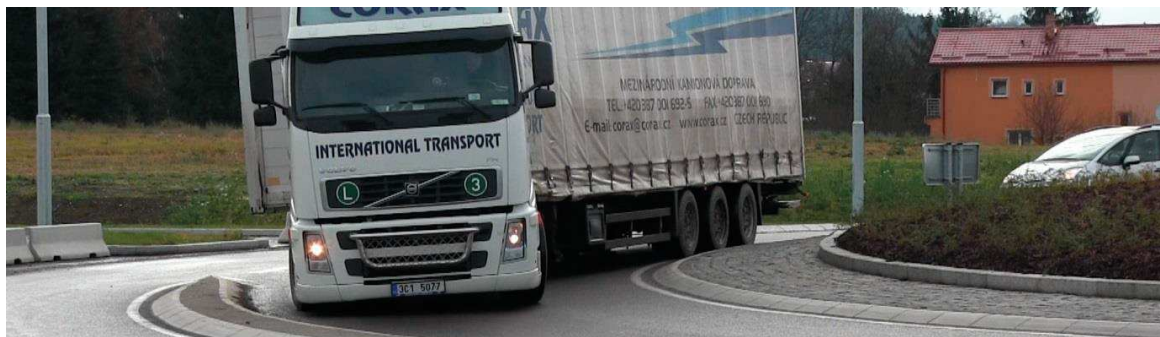
Obr. 65 Průjezd návěsové soupravy délky 16,5 m na TOK v Českých Budějovicích – Nové Hodějovice
