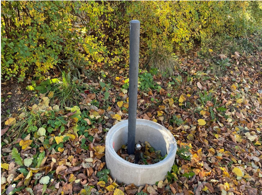
Příloha 8: Geologický vrt monitorující možný pohyb terénu v intravilánu obce Uhelná. Betonová skruž a plastová tyč chrání nerezovou hlavičku, jejíž výška je zaměřena přesnou geometrickou nivelací souřadnicového systému S-JTSK (foto autor – 28. 10. 2021).
