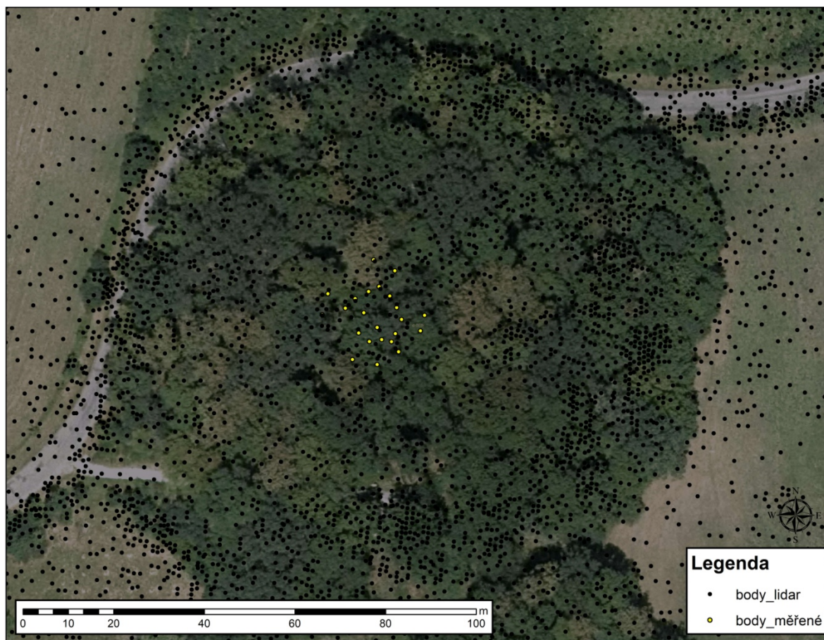
Obrázek 34: Vyobrazení geodetického měření v mračně bodů na podkladu ortofota (vegetace - les).
