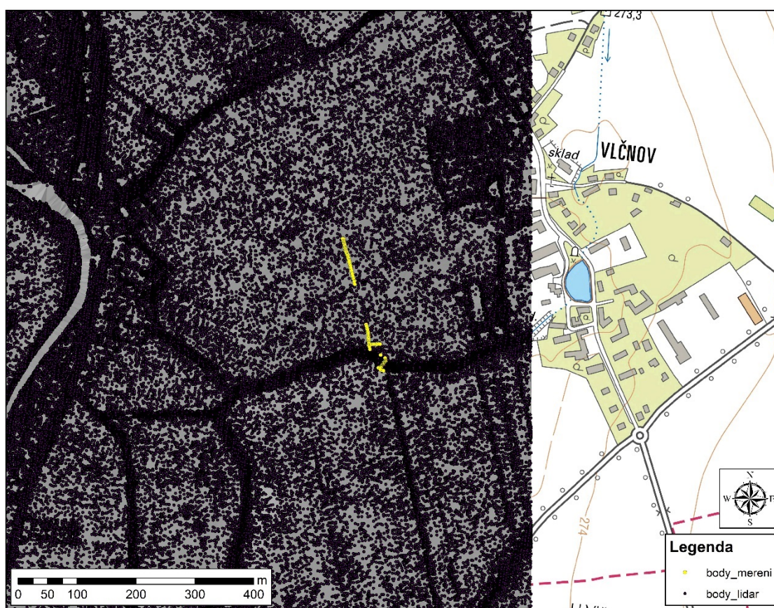
Obrázek 41: Vyobrazení geodetického měření (žlutě) v mračnu bodů na podkladu ZM 10 (volné prostranství a vegetační pokryv).
