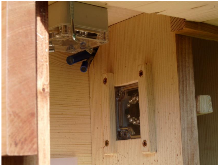
Příloha 1. Uchycení a umístění kamery, mikrofону a teplotního čidla (Foto M. Zárybnická).
