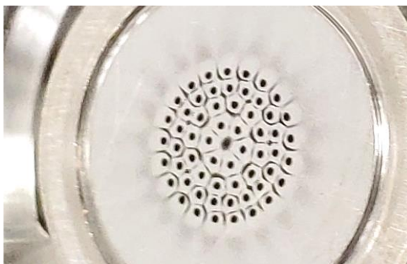
Obr. 30 Ukážka zachytených jemných častíc na povrchu impakčnej plochy
