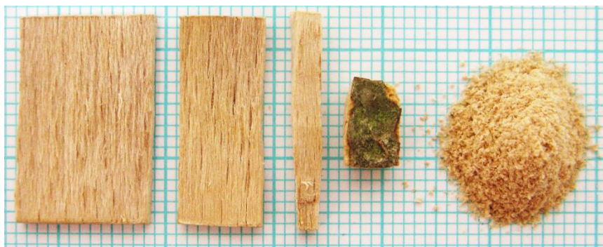
Obr. 38 Vzorky analyzované v prístroji TGA. Zľava: veľká, stredná a malá vzorka bukoveho dreva, kôra a piliny [43]
