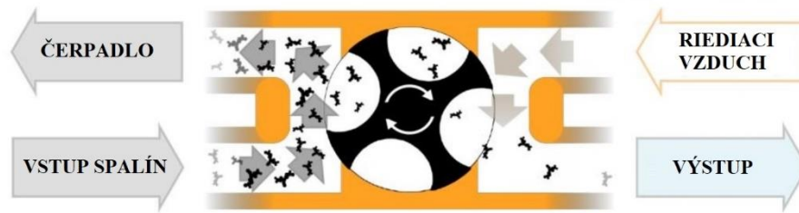
Obr. 26 Princíp fungovania riedičky s rotačným diskom [75], [76]
