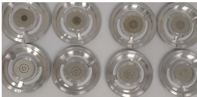
Obr. 96 Zachytené vzorky jemných částic na jednotlivých stupňoch impaktoru.
