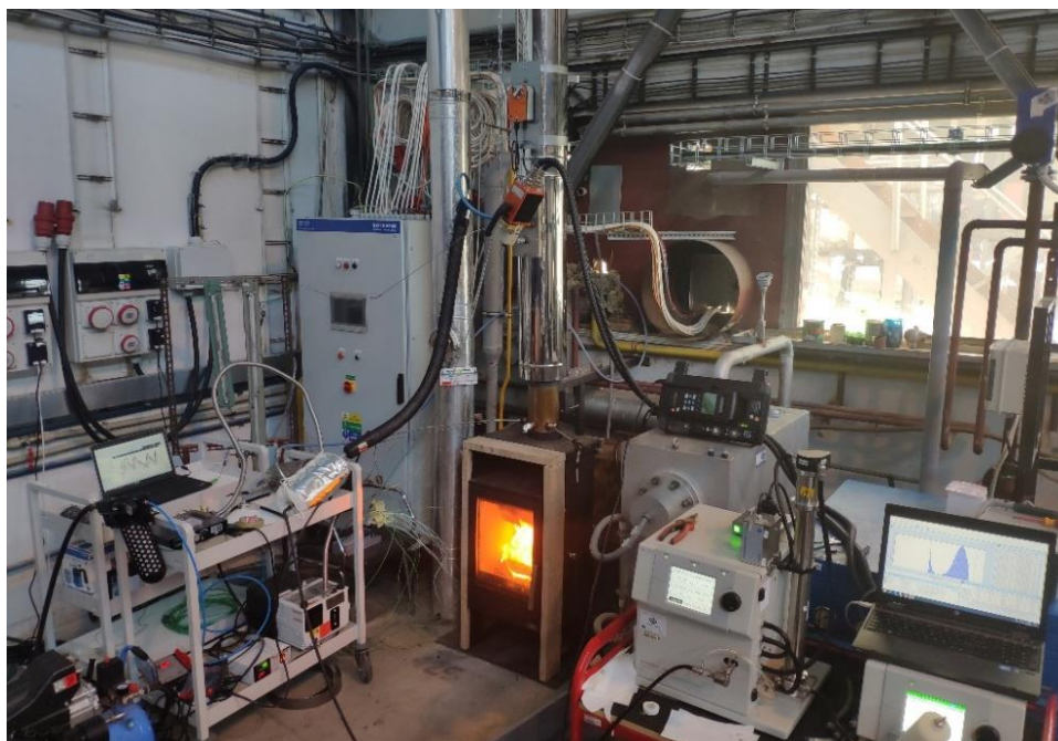
Obr. 67 Krb ABX Grönland a odbery vzorky spalin pre SMPS prístroj a analýzu plynov
