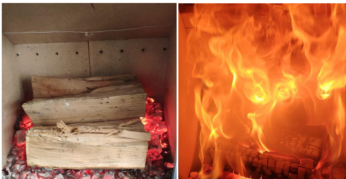
Obr. 81 Otvory pre prívod terciárneho vzduchu do ohniska (vľavo) a horenie paliva s prívodom terciárneho vzduchu (vpravo)
