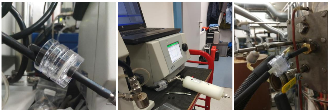
Obr. 32 Odber vzorky jemných častíc na filter pomocou SMPS zariadenia. Zapojenie odberovej kazety do prúdu častíc (vľavo); odber veľkostne roztriedených častíc priamo pred CPC zariadením (uprostred) a odber častíc priamo zo spalinovodu (vpravo).
