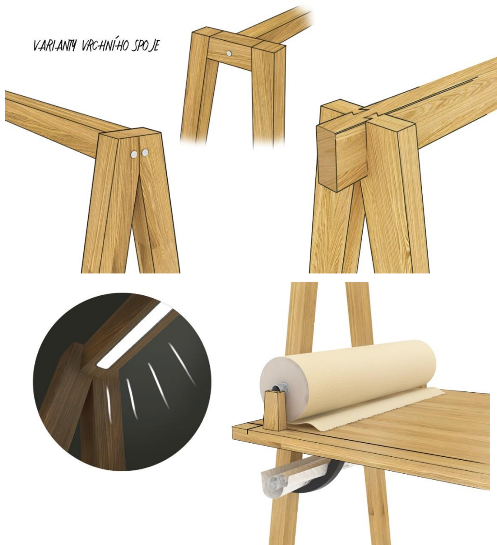
Obrázek 32 Varianty spoje nosné konstrukce a doplňkové návrhy (vizualizace autorka)
