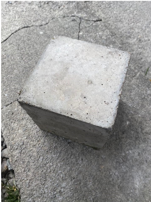
Obr. 2.12 Odliatok betónovej kocky po vykonaných skúškach
