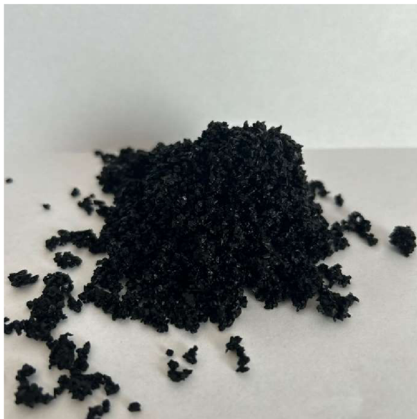
Obr. 5.8 Granulované uhlí Silcarbon S1240 [autor]
