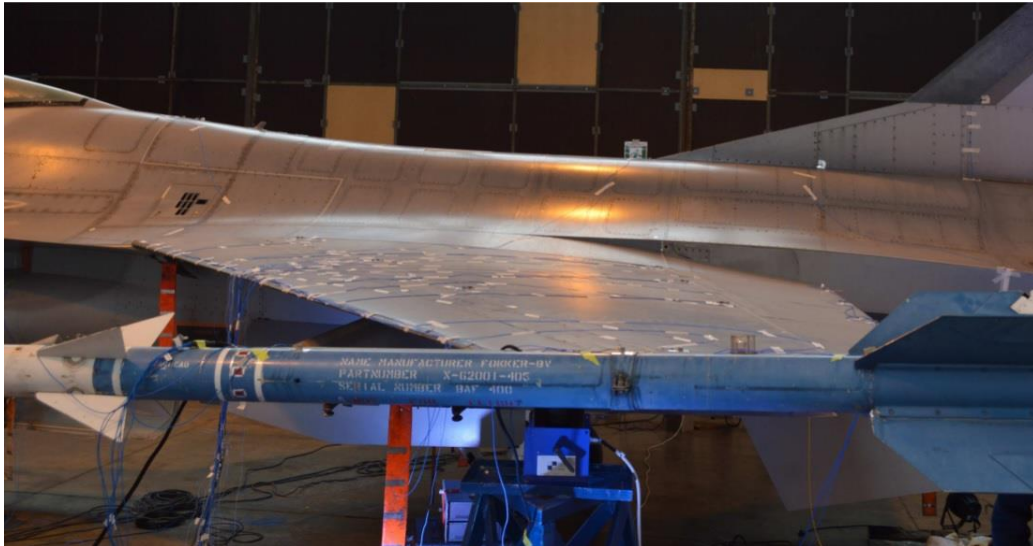
Obr.5.3: Krídlo lietadla F-16 pokryté tenzometrami [9]
