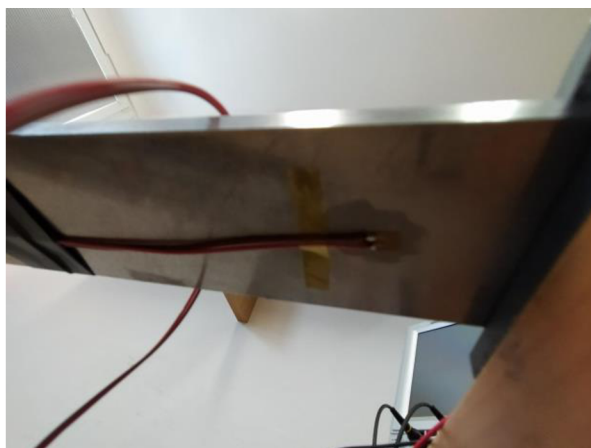
Obr.6.7: Umiestnenie tenzometru zo spodnej časti nosníku
