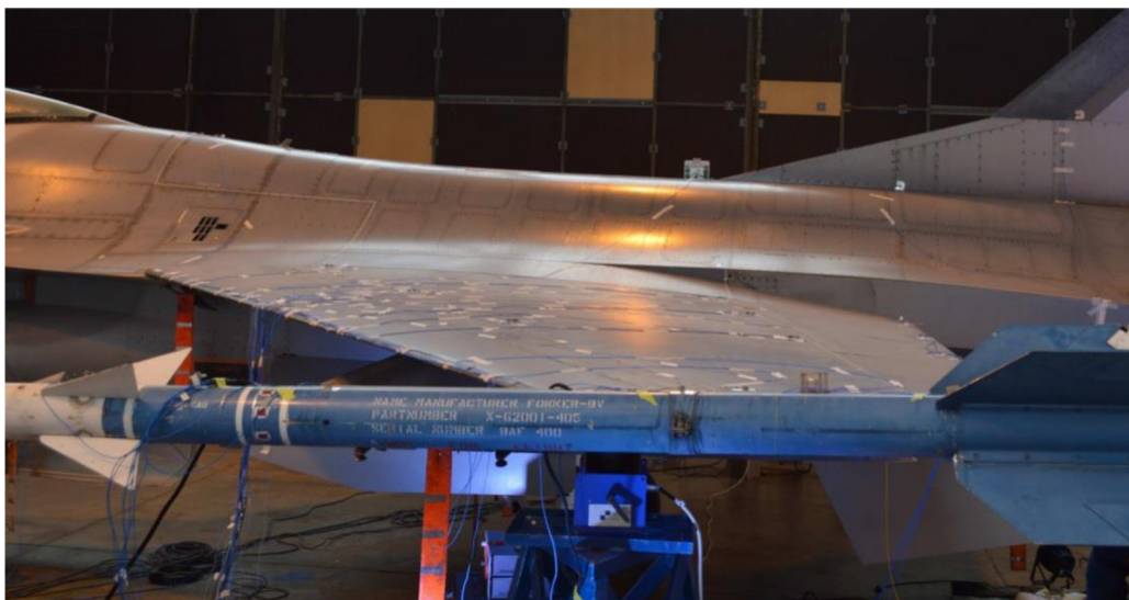
Obr.5.3: Krídlo lietadla F-16 pokryté tenzometrami [9]
