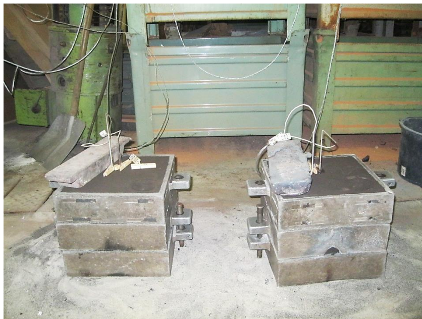
Obr. 6.8 Umístění forem na licím poli
