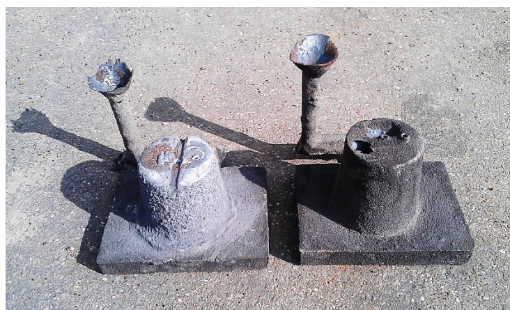
Obr. 6.11 Výsledné odlitky: s exotermickým obkladem (nalevo) a obyčejný (napravo)
