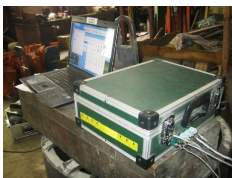
Obr. 6.9 AD převodník zapojený do PC
