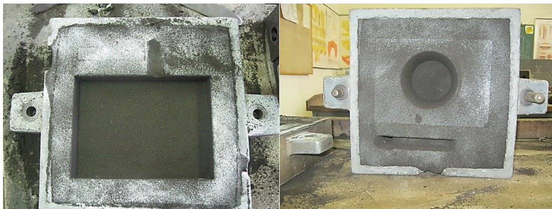
Obr. 6.6 Výroba formy. Spodní část (vlevo) a horní část (vpravo)
