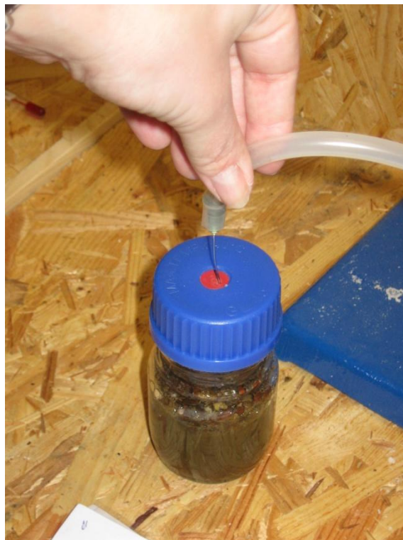
Obrázek č. 2. Průběh měření produkce bioplynu
