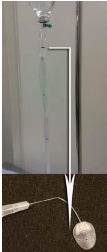
Obrázek 20 Gravitační testovací systém průtoku tekutiny skrz Ahmedovu chlopně (Jones 2013).
