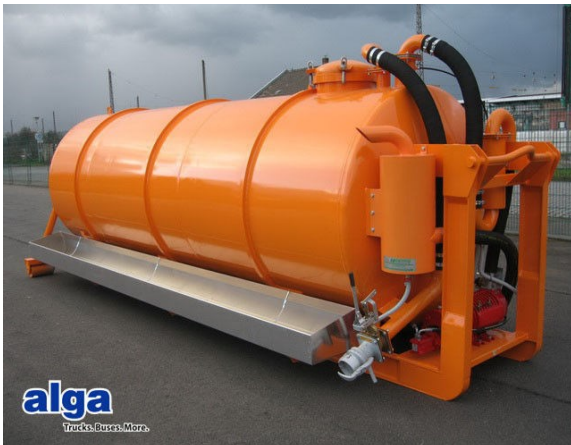
Obr.3.2 Ukázka konstrukce odvalovacího kontejneru s cisternovou nástavbou
