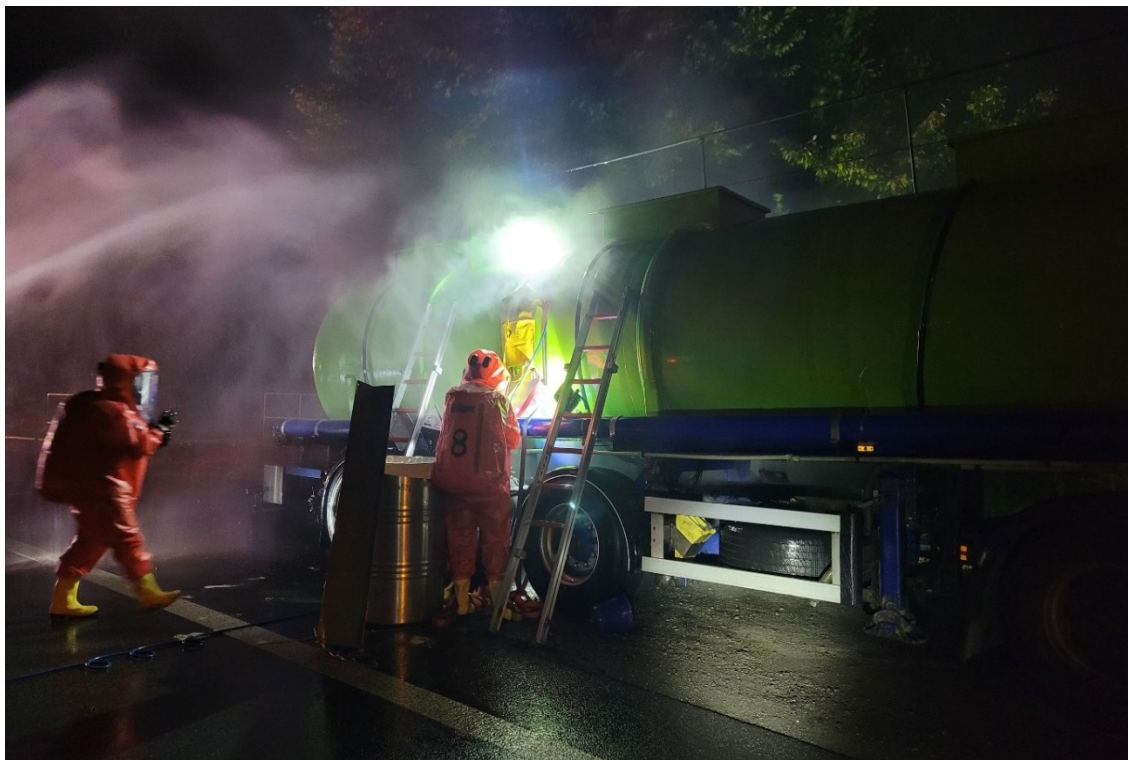
Obr. 2.2 Pohled na zajištění trhliny pláště cisterny za současného zkrápění par Zdroj: interní zdroje HZS (fotodokumentace ze zásahu)
