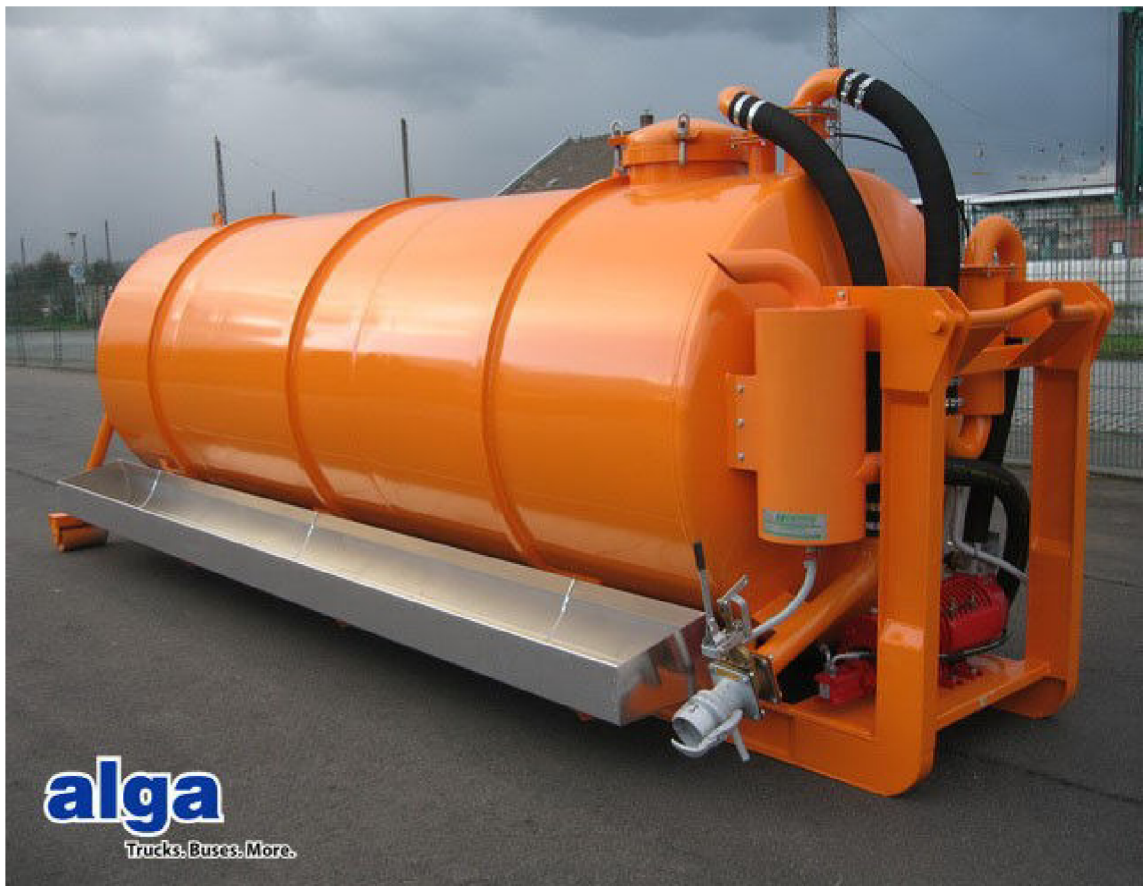
Obr.3.2 Ukázka konstrukce odvalovacího kontejneru s cisternovou nástavbou
