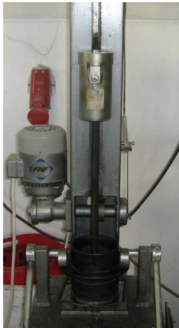
Obr. č. 8 Marshallův pěch
