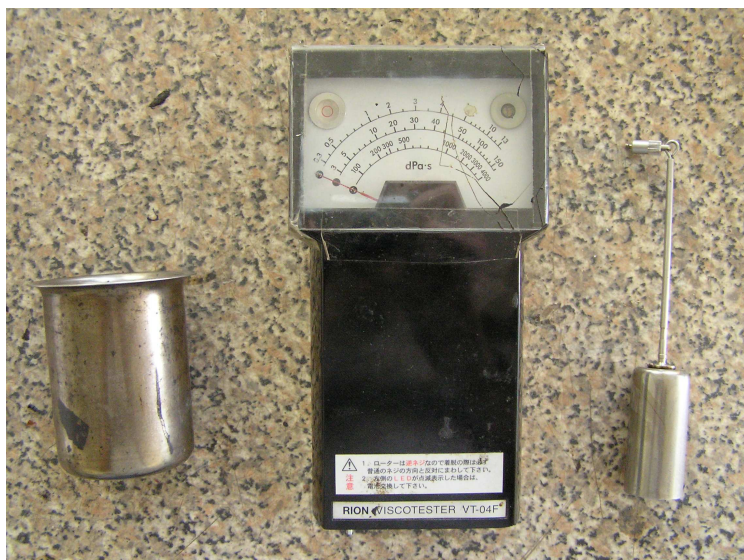
Obr. č. 5 Viskozimetr RION
