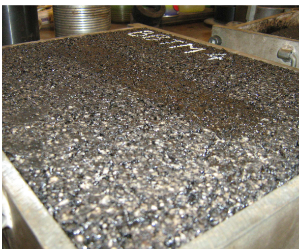
Obr. č. 20 výsledná vyjetá kolej
