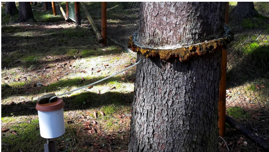
Obr. 3. Část srážek dočasně zadržena vegetací, stéká po kmeni stromů (stemflow). Na obrázku je měřicí nádoba na stok umístěná na smrku ztepilém ( Picea Abies (L.) Karst.) v prostorách monitorovacího objektu experimentálního povodí Liz. (Autor, 2017)
