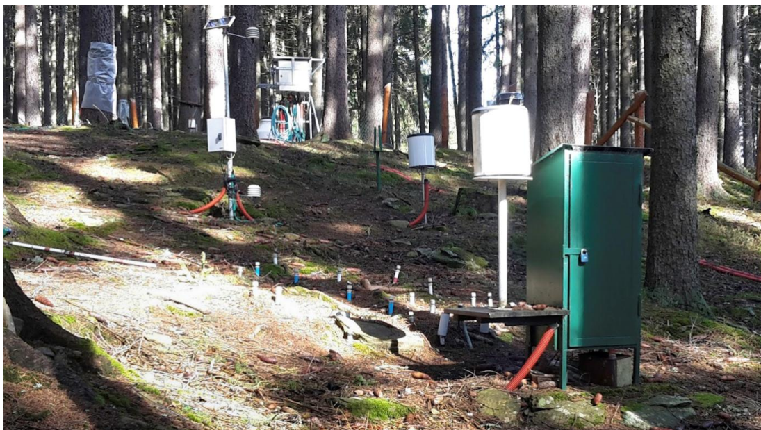
Obr. 2 Příkladem způsobu měření srážek je vybavení v prostorách monitorovacího objektu experimentálního povodí Liz – v popředí je automatické měření srážek za časový úsek zn. Fiedler, dále zařízení na měření podkorunových srážek ( throughfall ). V pozadí je také automatická stanice pro měření teploty a vlhkosti vzduchu ve dvou metrech nad zemí a přízemní minimální teploty vzduchu. (Autor, 2017)
