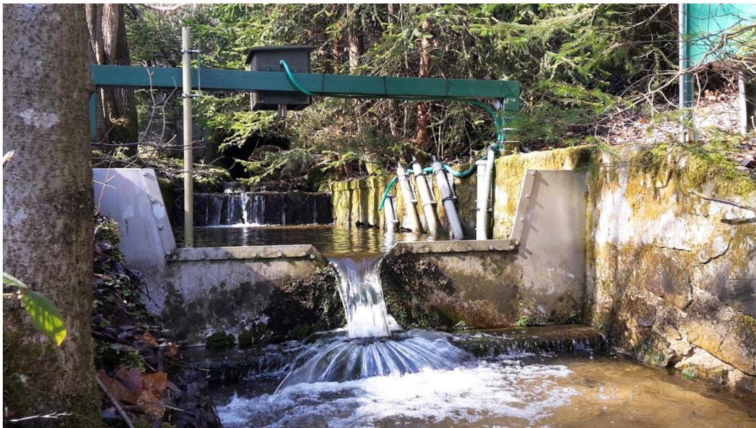
Obr. 4 – Závěrný profil experimentálního povodí Liz – tento je řešen Thomsonovým pravouhlým přelivem, který je kombinován s Cipolettioho lichoběžníkovým přelivem. Součástí profilu jsou také sondy na měření fyzikálně-chemických parametrů, jako jsou pH, Eh, teplota, konduktivita a obsah rozpuštěného O 2 . V konstrukci nad hladinou je také umístěn ultrazvukový elektronický průtokoměr. (Autor, 2017)
