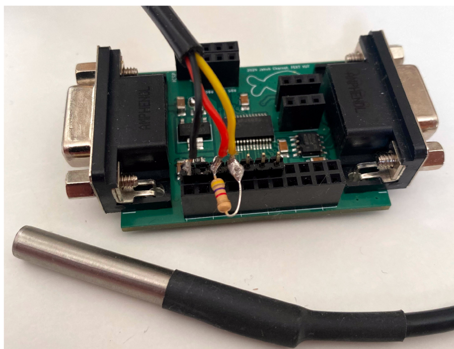
Obr. 5.2: Realizovaný sensor teploty s čidlem DS18B20.
